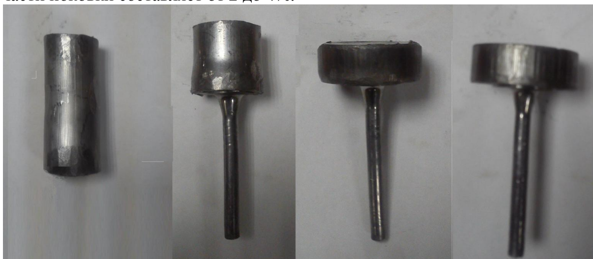
Рисунок 11 – Экспериментальное исследование относительного удлинения. а – заготовка, б – поковка после операции выдавливания, в – окончание стадии
