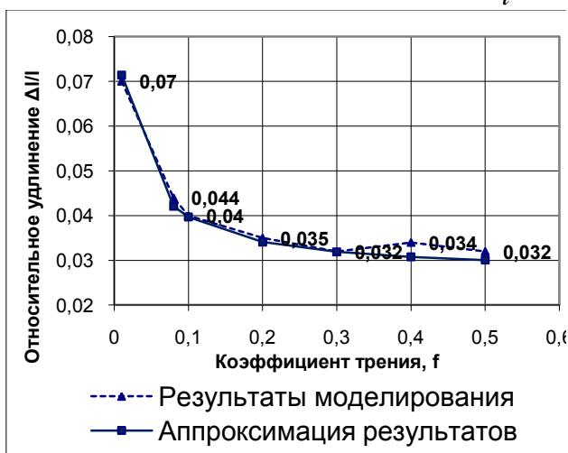
Рисунок 10 – Зависимости относительного удлинения перьевой части от коэффициента трения
