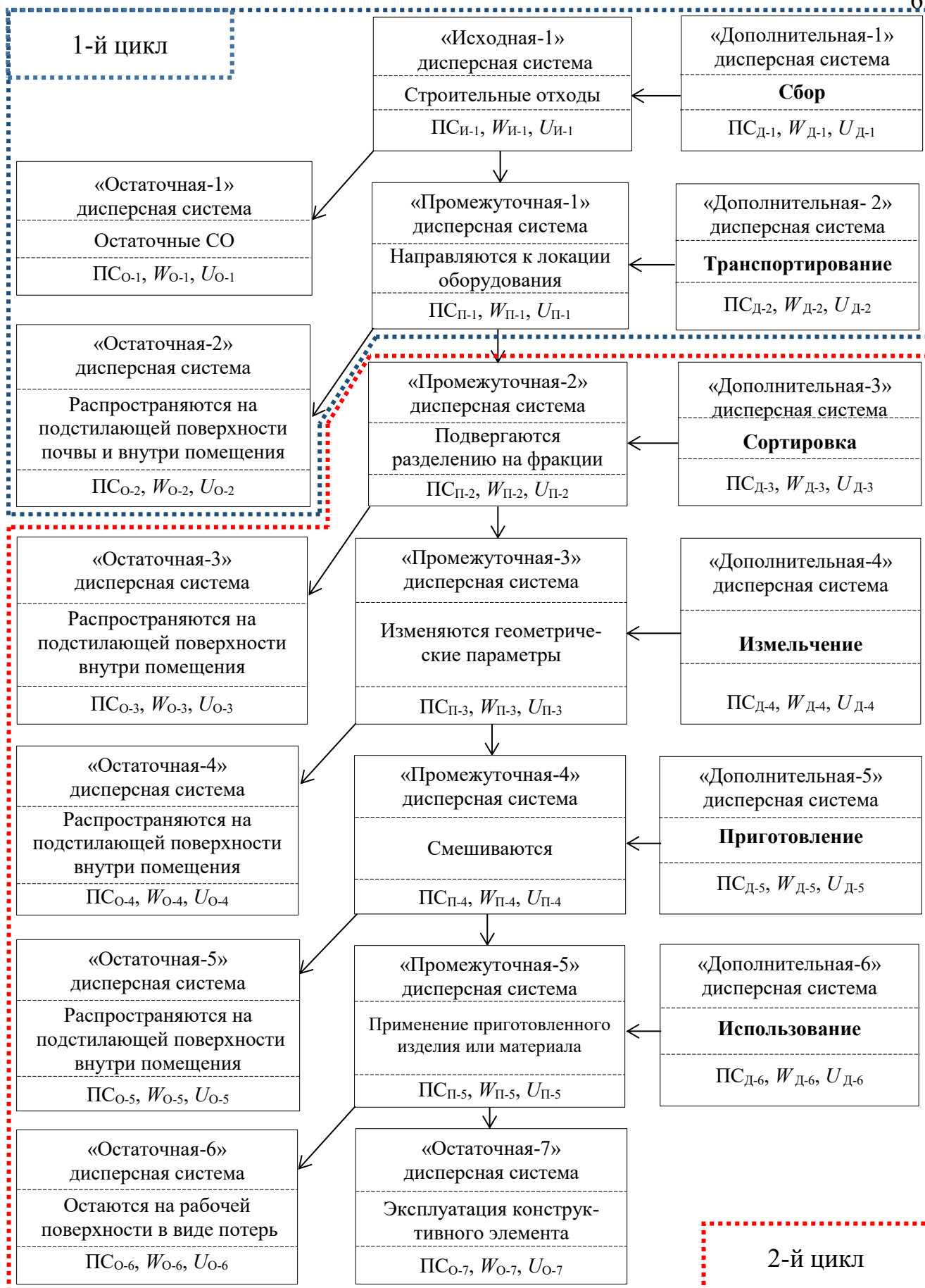
Рисунок 2.6 – Блок-схема процесса уменьшения поступления строительных отходов в окружающую среду
