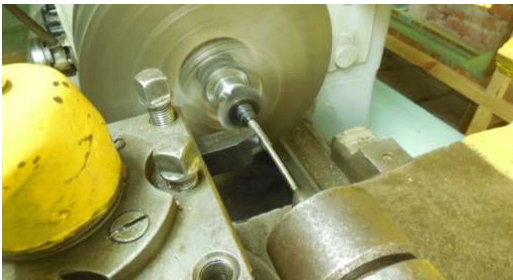
Рисунок 8 – Выглаживание поверхности вала турбокомпрессора после электроискровой обработки
