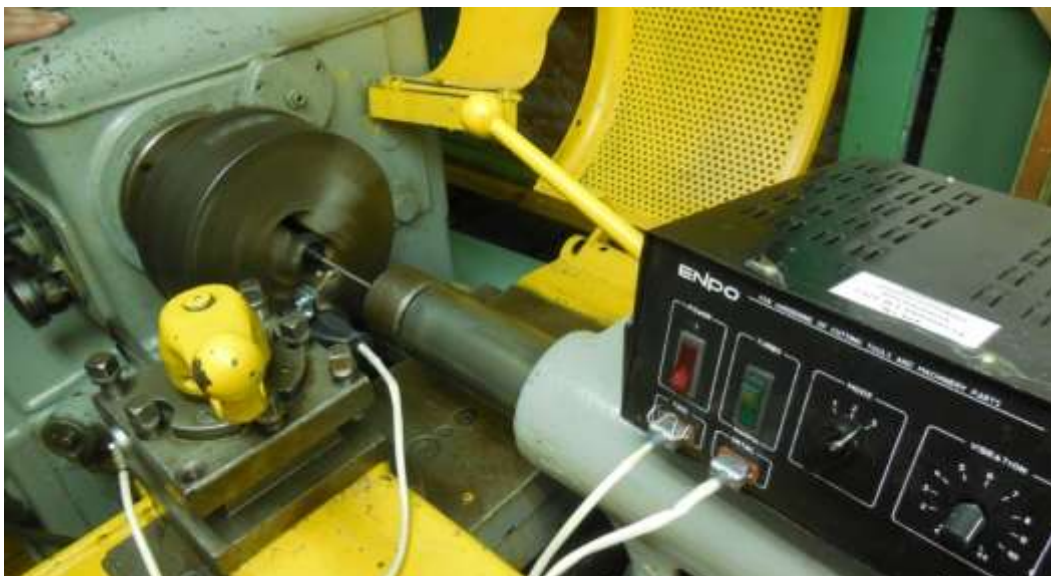
Рисунок 7 – Токарный станок с интегрированной в него установкой для электроискровой обработки UR-121
