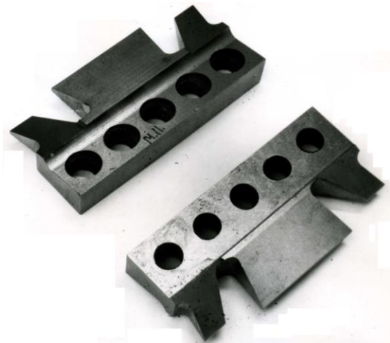
Рис.7. Зубострогальные резцы с дифференцированной схемой резания
