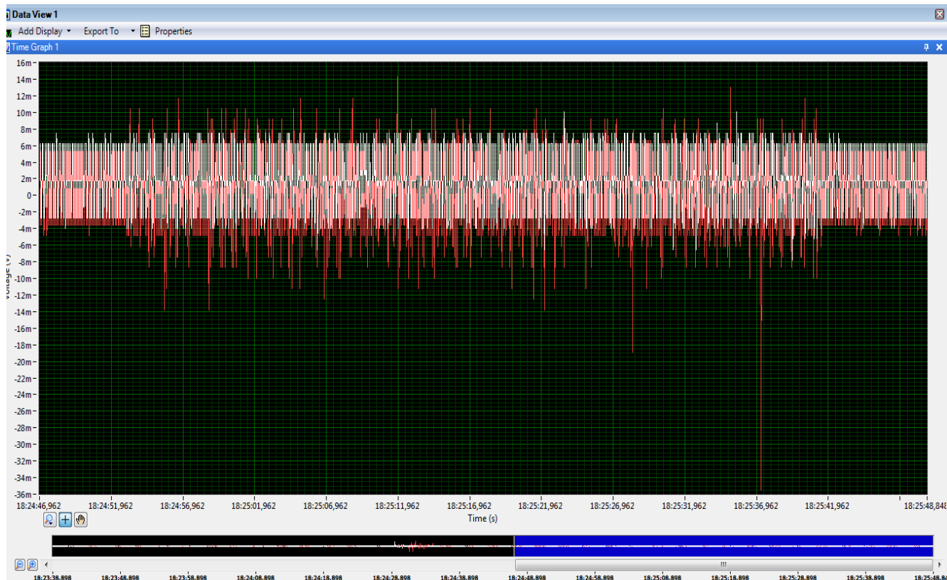
Рисунок 4.17 - Общий вид совместного графика зависимости виброускорения от времени проведения эксперимента для шарнира №1 с величиной осевого зазора 0,01мм
