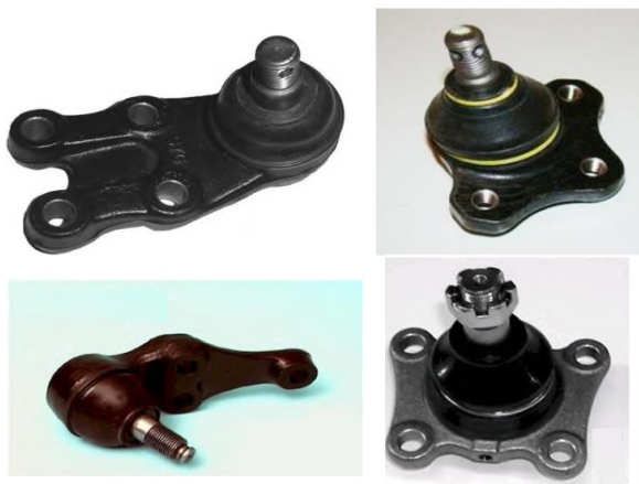
Рисунок 1.4 - Различные варианты конструкций шаровых шарниров используемых в подвесках автомобилей
