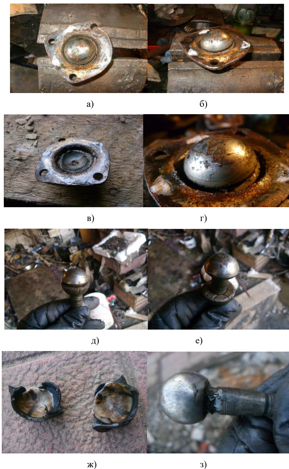
Рисунок 1.8 - Элементы шаровых шарниров бывших в эксплуатации: а, б – коррозия шарового пальца и корпуса шарового шарнира, абразивный износ шарового пальца; в – абразивный износ вкладыша, следы коррозии на нем, коррозия корпуса шарового шарнира; г - коррозия шарового пальца и корпуса шарового шарнира, абразивный износ шарового пальца; д, е - коррозия шарового пальца, абразивный износ шарового пальца в виде радиальных канавок на сферической поверхности; ж – деstrukция; з – абразивный износ сферической головки и усталостный износ в сечении перехода сферической части в коническую шарового пальца.
