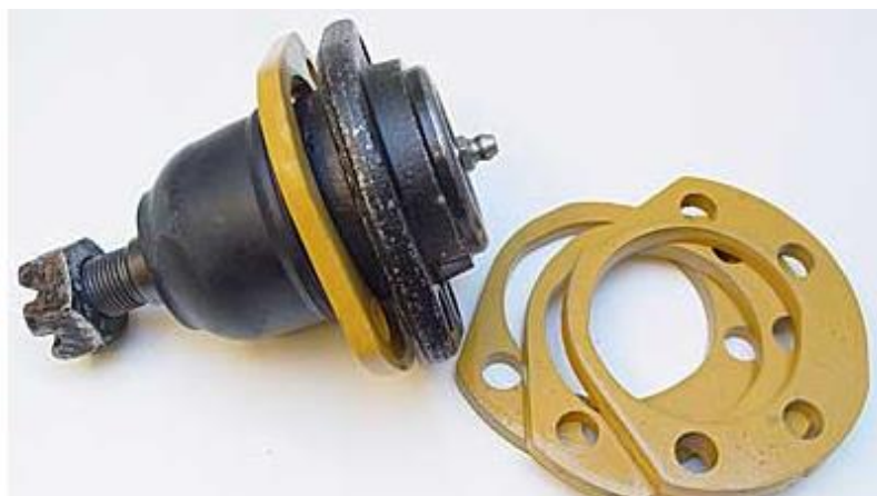
Рисунок 1.6 - Пример шарового шарнира требующего технического обслуживания
