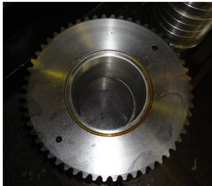
Рисунок 8 - Зубчатое колесо передачи Новикова m=8 , z=56 , \beta=17^{\circ}0'0''
