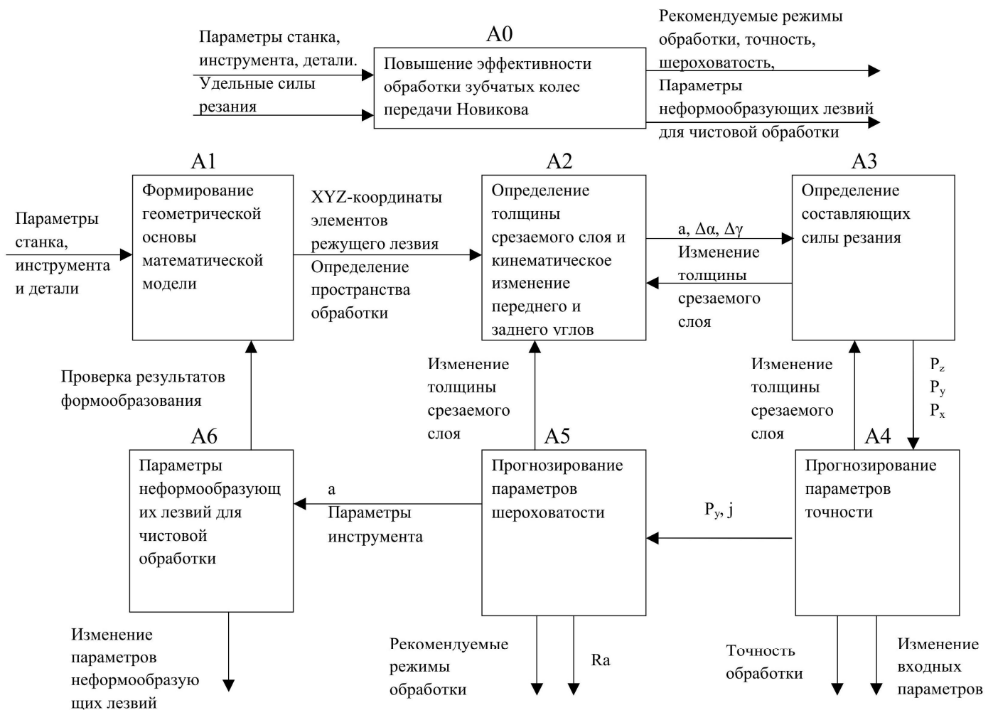
Рисунок 6 – Управление процессом обработки зубчатых колес передачи Новикова
