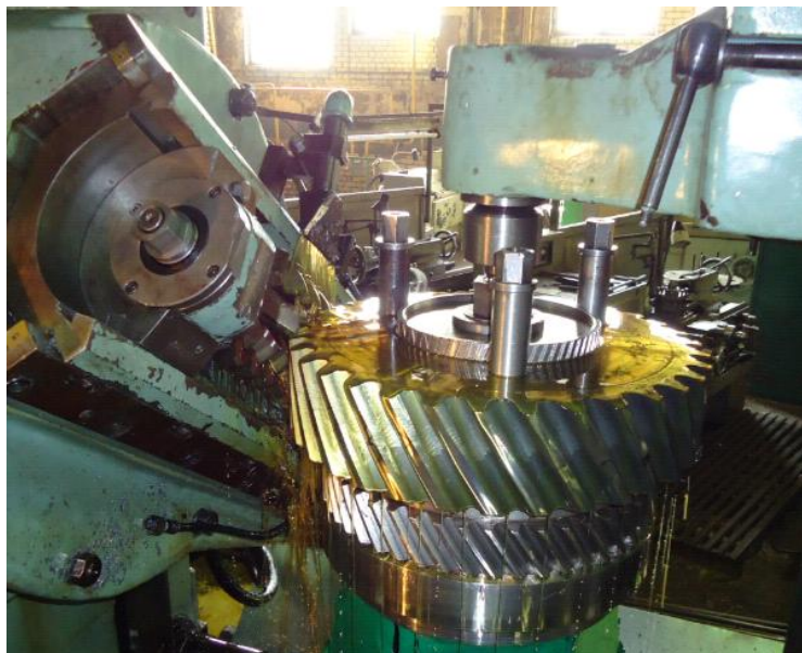
Рисунок 7 - Обработка зубчатого колеса передачи Новикова
