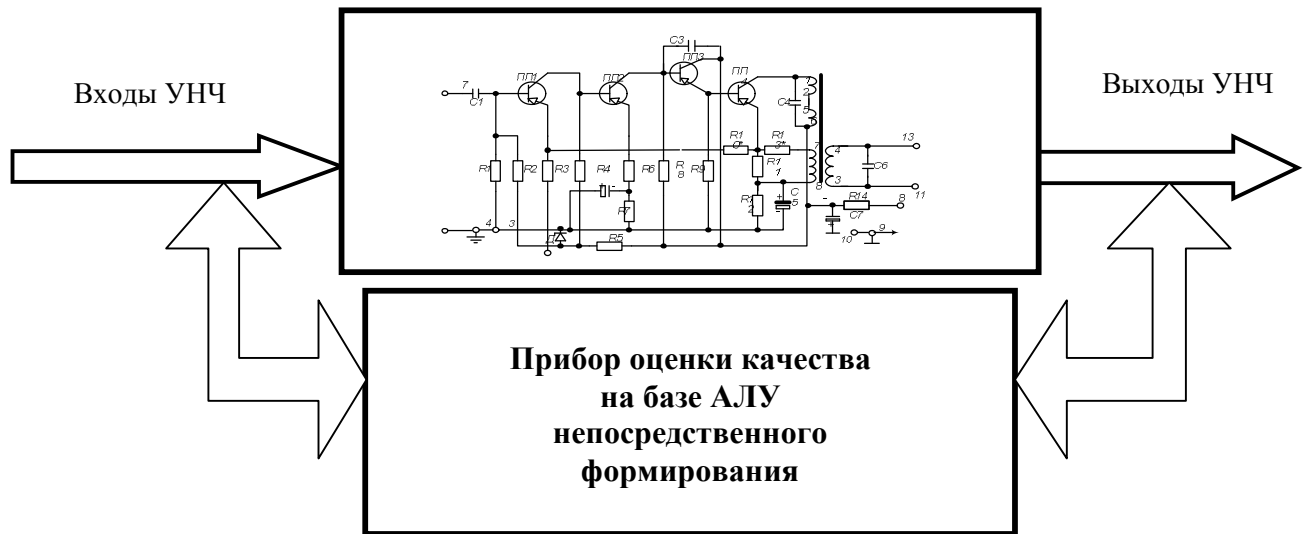
Рисунок 65 – Структурная схема измерительной системы оценки качества функционирования усилителей низкой частоты
