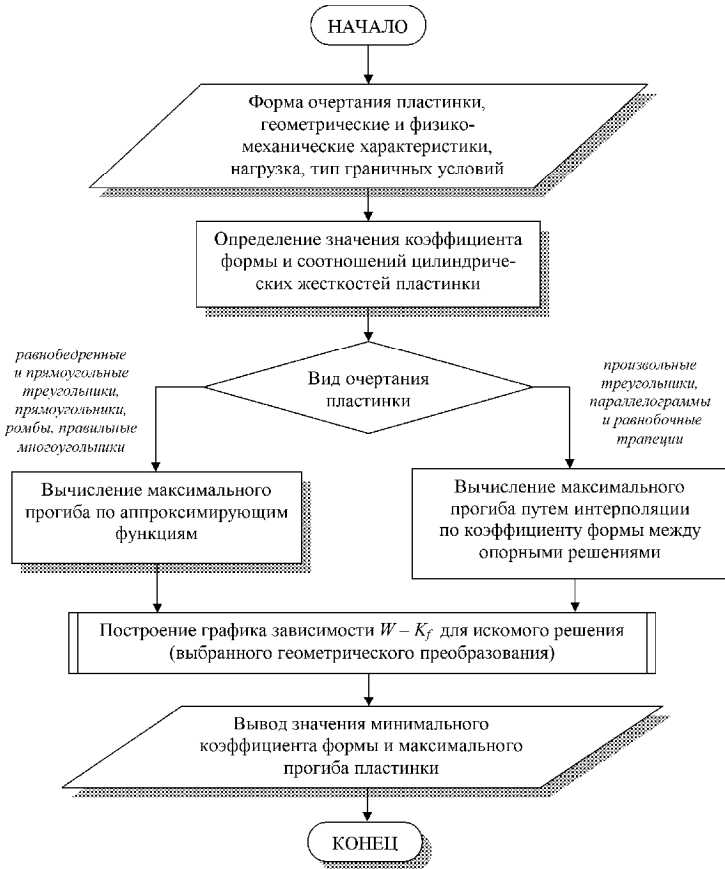
Рисунок 10 – Общий алгоритм работы программы «OrthPlate»
