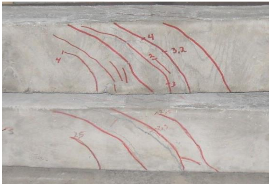
Рис. 1.17. Характер трещинообразования в опытных железобетонных и фиброжелезобетонных балках: а – центральный фрагмент фиброжелезобетонной балки с содержанием фибрового армирования 1,5% (боковая и нижняя поверхность); б – центральный фрагмент опытных балок снизу – железобетонная; сверху – фиброжелезобетонная с содержанием фибрового армирования 1,5%)
