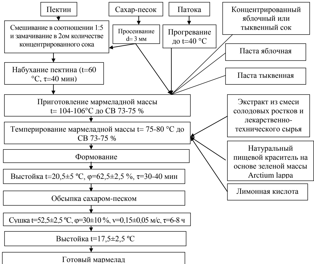
Рисунок 5.9 – Технологическая схема производства желеино-фруктового (желеино-овощного) мармелада повышенной пищевой ценности
