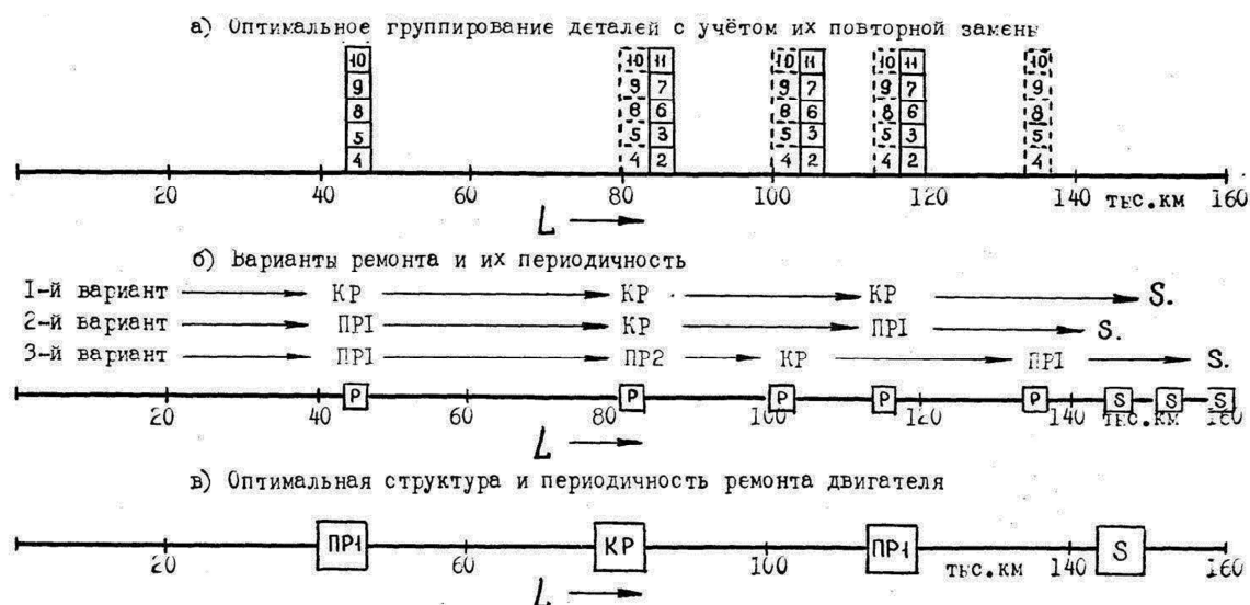
Рисунок 4.4 - Формирование структуры и периодичности ремонтного обслуживания двигателей ЯМЗ-240Н:
