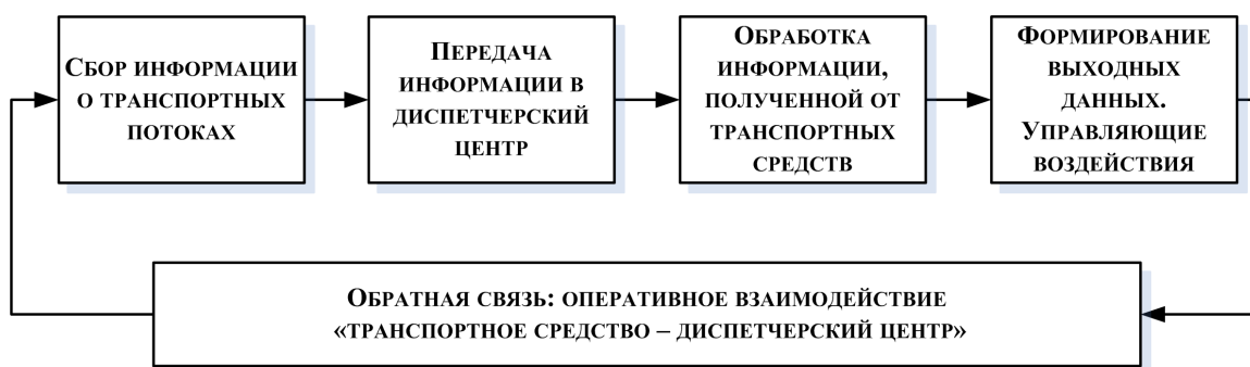
Рисунок 1.2 – Укрупненная схема технологии автоматизированного управления транспортом
