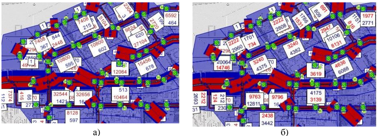
Рисунок 4.25 – Распределение транспортной нагрузки а) при существующем пассажиропотоке и маршрутной сети; б) при прогнозируемом пассажиропотоке (оптимистичный прогноз)
