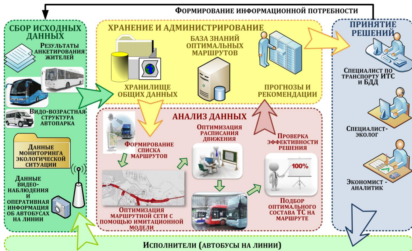
Рисунок 3.1 – Концептуальная модель системы управления городскими автобусными перевозками
