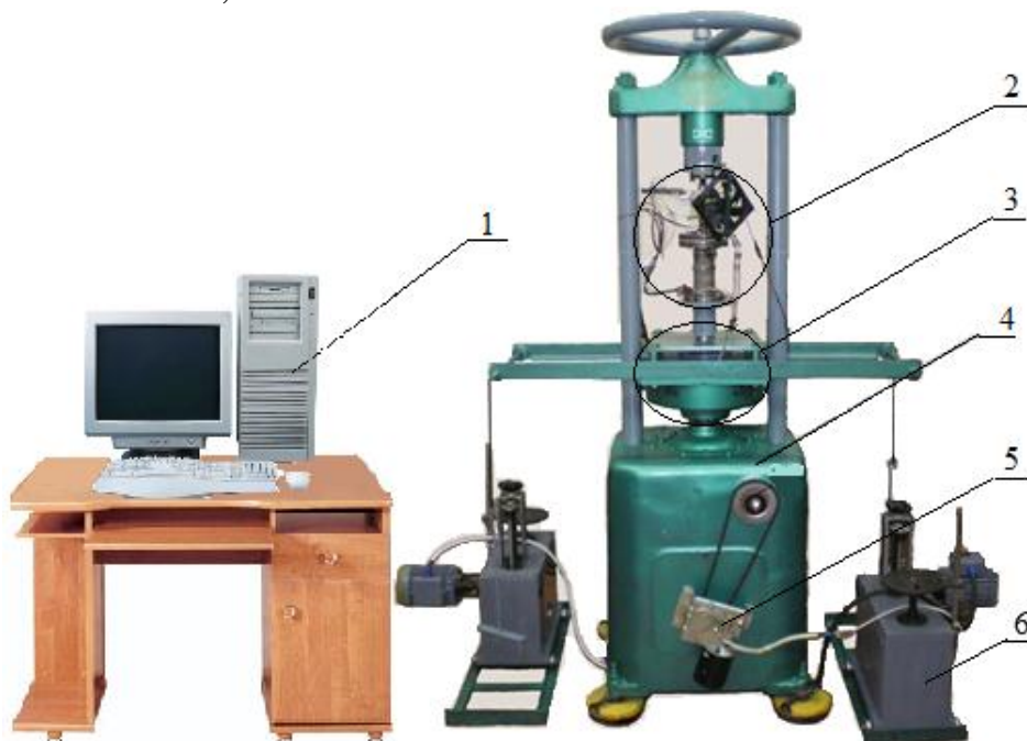
Рисунок 1 – Фотография автоматизированного рабочего место и основных блоков УИМ СНТ: 1 – комплекс измерительно-регистрирующей аппаратуры, 2 – рабочая часть 3 – блок растяжения (сжатия)-кручения, 4 – станина, 5 – привод растяжения (сжатия), 6 – привод кручения
