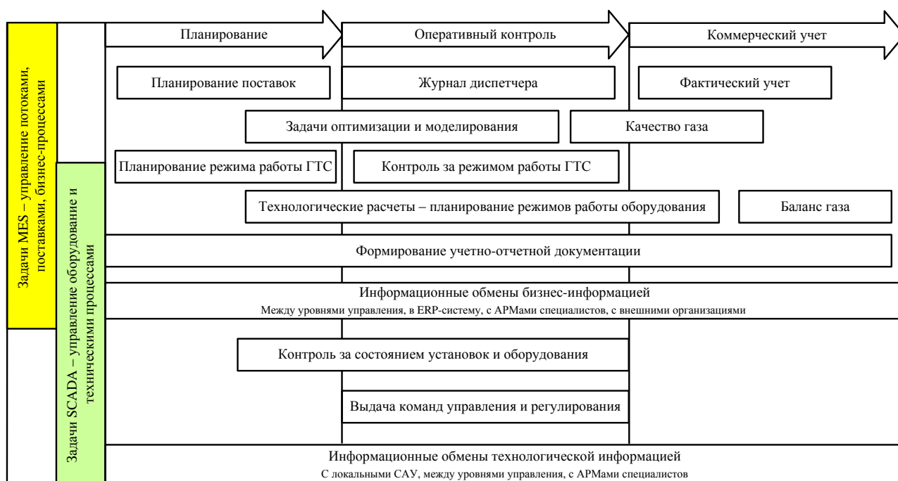
Рис. 1.1. Вариант представления производственно-технологических функций в диспетчерском управлении ГДП и ГТП
