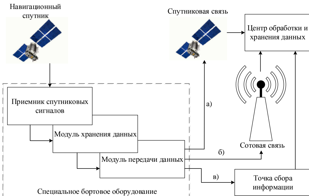
Рисунок 1.9 – Процесс построения КМК на основе трекинга ТС с помощью ГНСС
