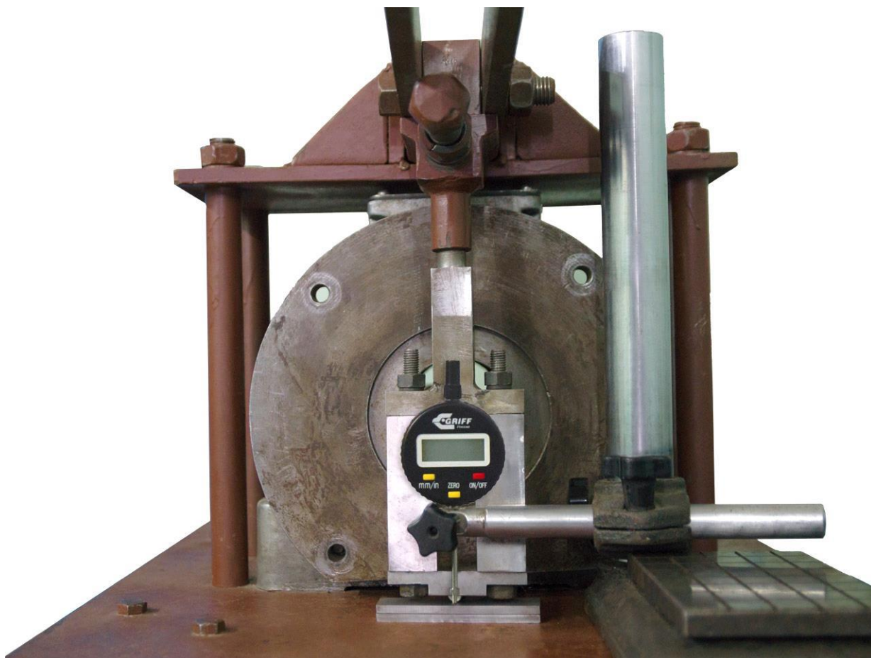
Рисунок 3.14 – Исследование коэффициента податливости упругого основания
