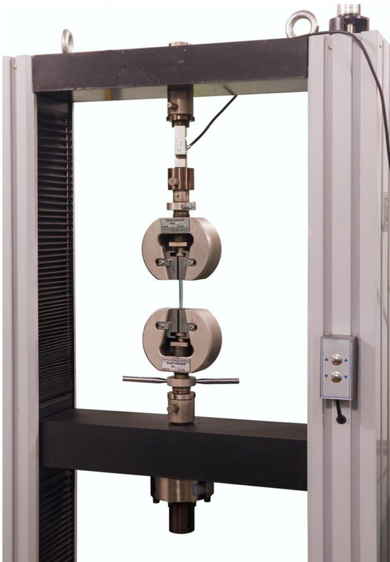
Рисунок 3.3 – Исследование деформационно-прочностных свойств пленок акрилового адгезива АН-110 на разрывной машине ИР 5082-50
