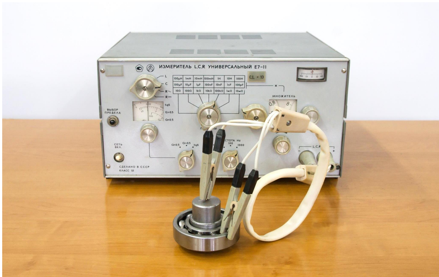
Рисунок 3.7 – Исследование процесса полимеризации композиции на основе адгезива АН-110 прибором Е7-11
