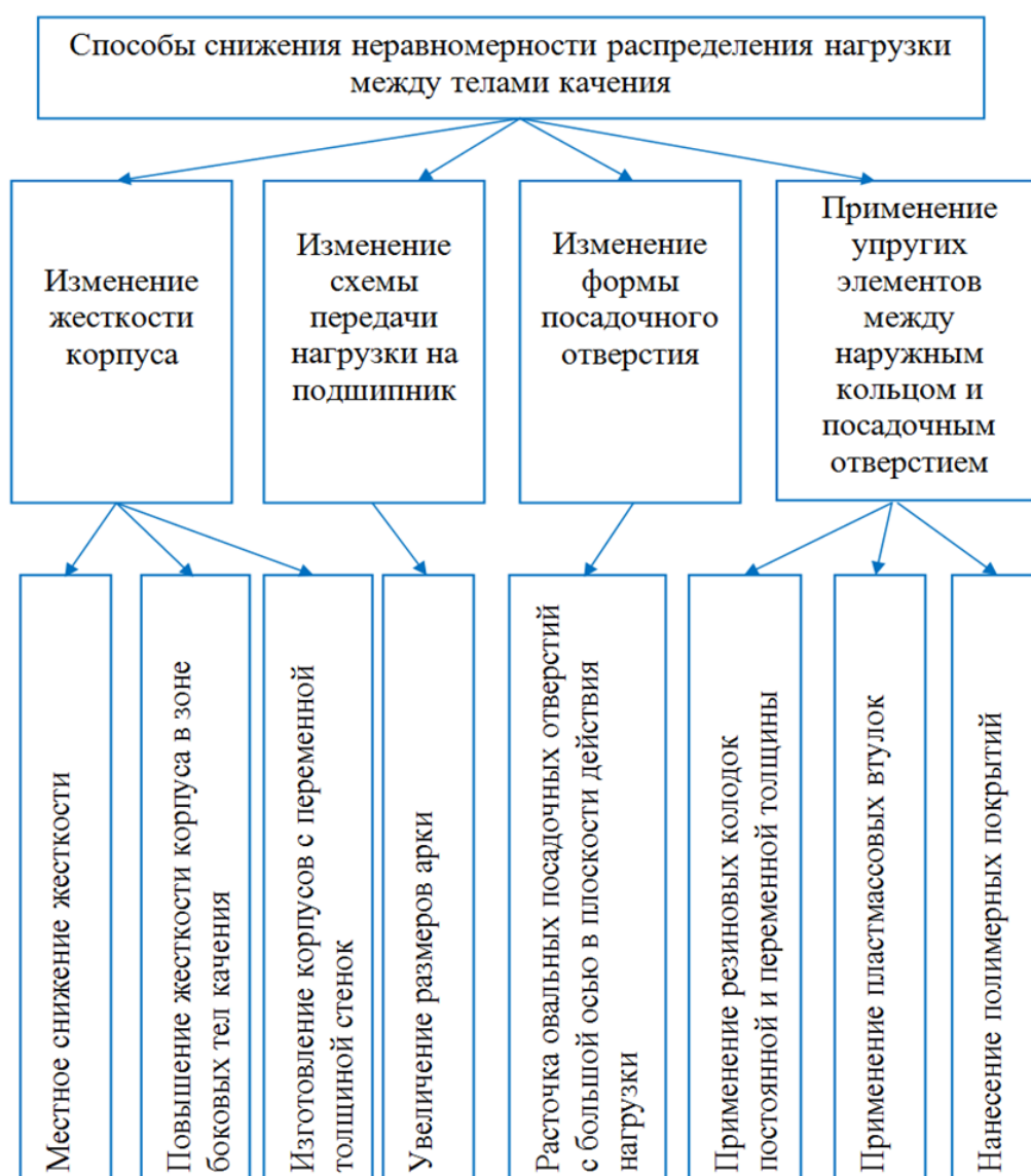
Рисунок 1.1 – Классификация способов снижения неравномерности распределения нагрузки между телами качения в подшипниках
