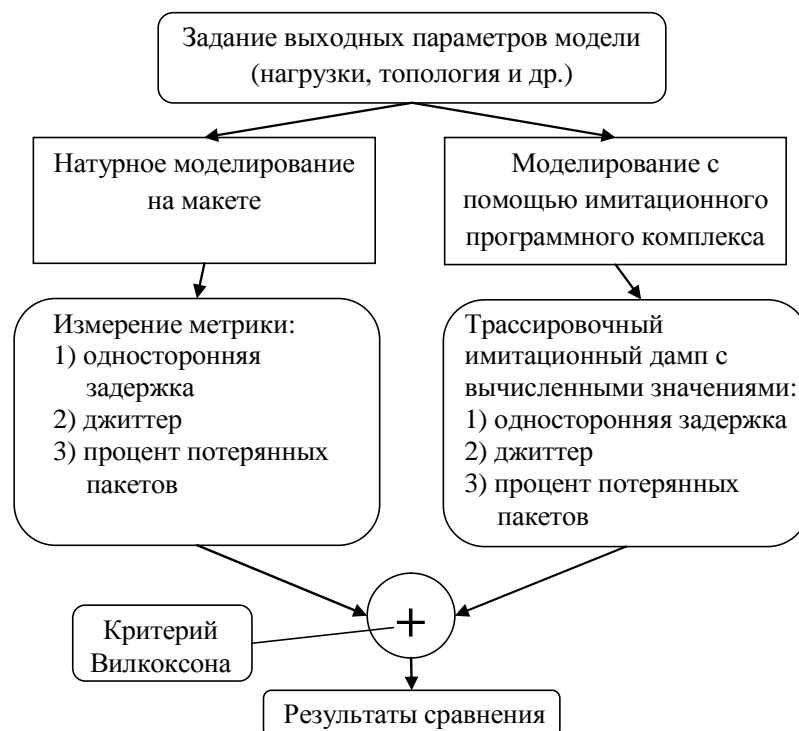
Рисунок 5.10 – Схема проверки имитационной модели на адекватность [113]
