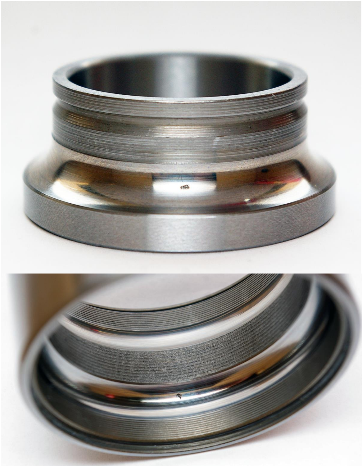
Рисунок В.1 - Дефекты на кольцах.
