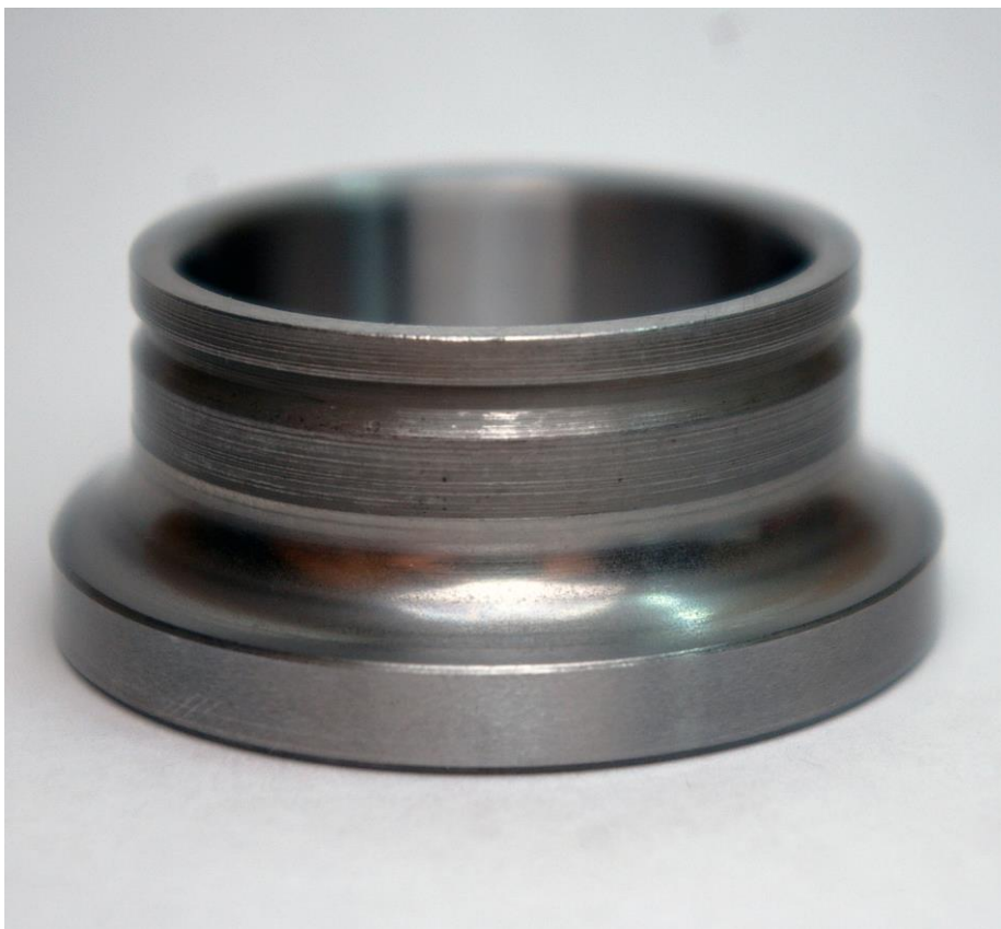
Рисунок В.2 - Дефекты при абразивном изнашивании
