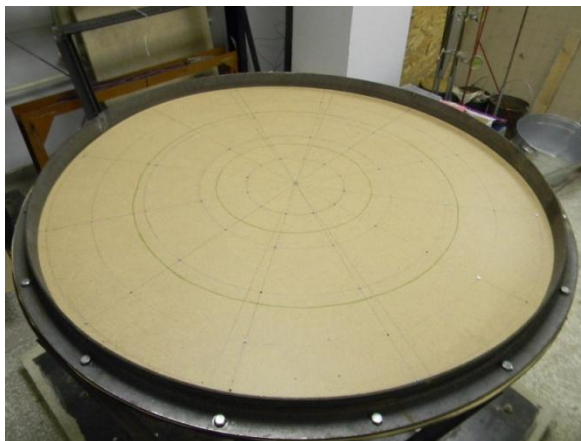
Рисунок 4.23 –Составная круглая пластина на испытательном стенде
