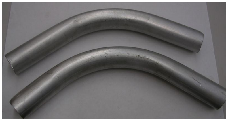
Рисунок 38 – Образцы трубы 30x1,8 мм из сплава Д16М, изогнутые на лабораторной установке
