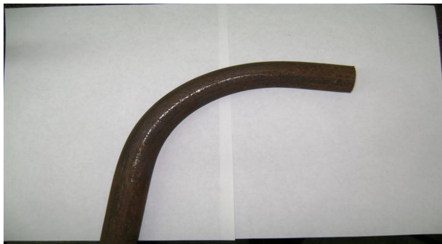
Рисунок 37 – Образец трубы 32x3 мм из стали 20, изогнутый на лабораторной установке
