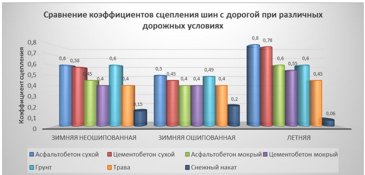
Рисунок 4.13 – Зависимость коэффициента сцепления от дорожных условий
