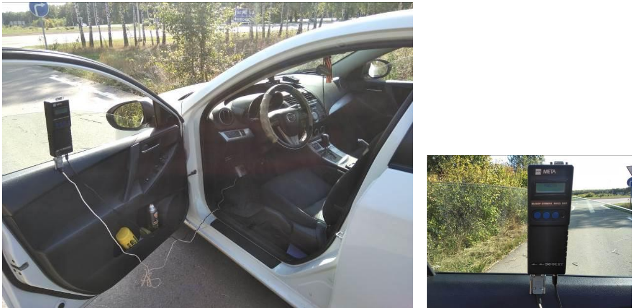
Рисунок 4.14 – Автомобиль Mazda 3 с установленным на нем прибором Эффект-02
