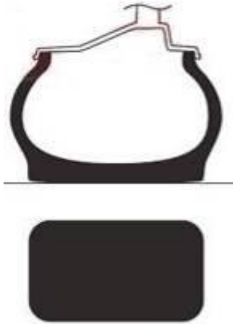
Рисунок – 3.3. Недеформированная шина колеса и статическое состояние пятна контакта
