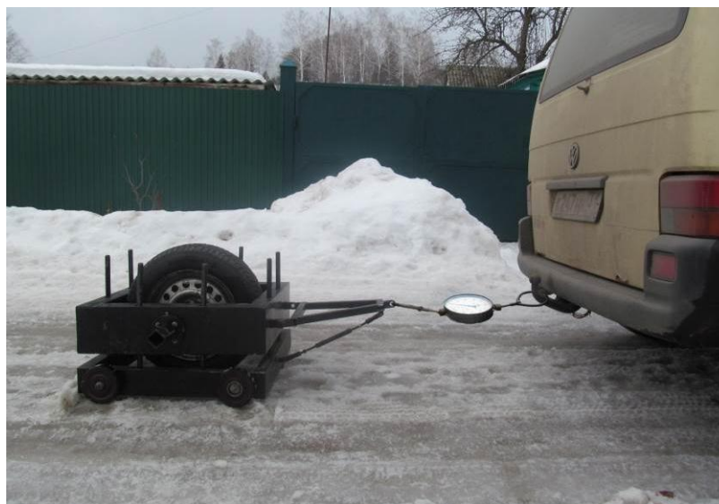
Рисунок 4.6 – Общий вид экспериментального стенда соединенного с ТС при испытаниях в зимнее время года
