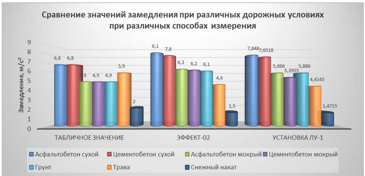
Рисунок 4.15 – Зависимость замедления от дорожных условий
