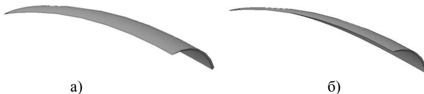
Рисунок 12 – Модели срезаемых слоев: а – фрезерование с возвратно-качательным движением подачи дисковым инструментом; б – построчное фрезерование дисковым инструментом
