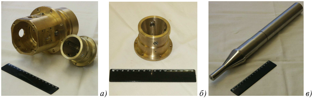
Рисунок 5.4 Детали подшипниковой установки: а) втулка; б) конический ГСП; в) ротор
