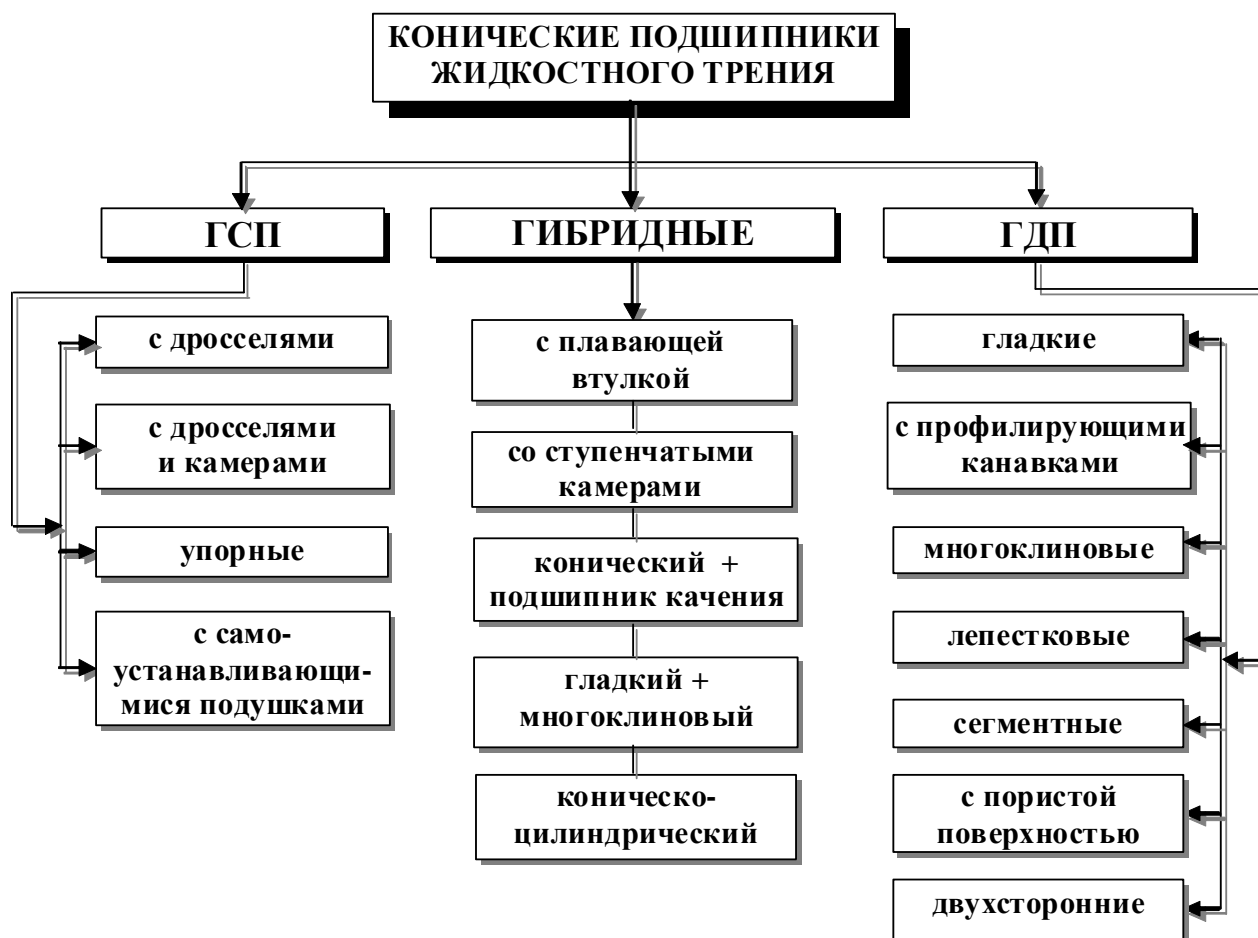
Рисунок 1.18 Классификация конических подшипников жидкостного трения
