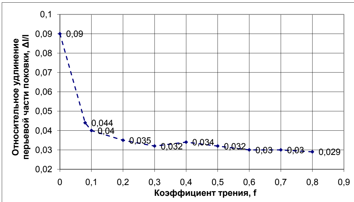
Рисунок 3.15 – Зависимость относительного удлинения перьевой части от коэффициента трения.
