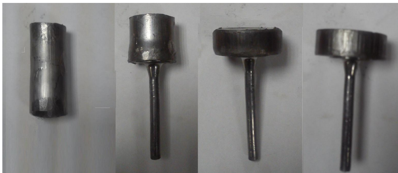
Рисунок 3.20– Экспериментальное исследование относительного удлинения. а – заготовка, б – поковка после операции выдавливания, в – окончание стадии осадки, начало стадии доштамповки, г – конец стадии доштамповка.
