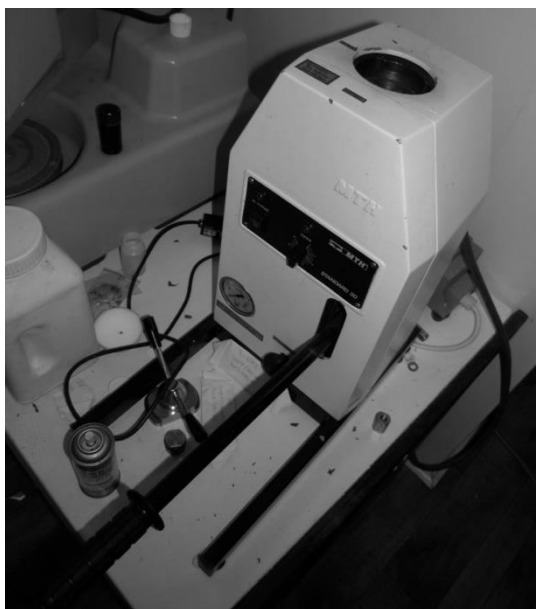
Рис. 2.12. Металлографический пресс МТН STANDART 30
