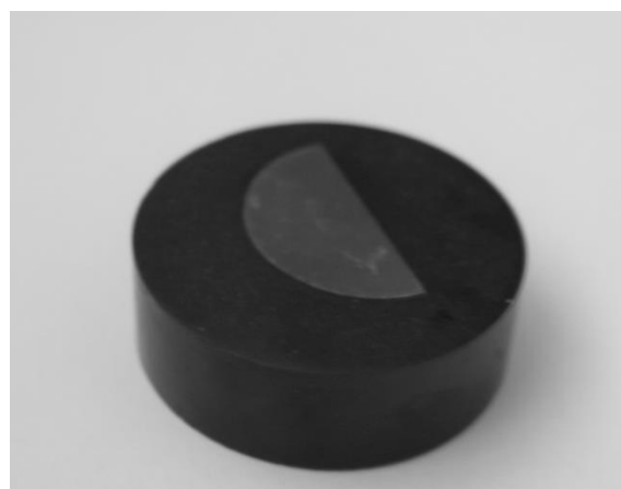
Рис. 2.14. Образцы изготовленные горячим прессованием и холодной заливкой
