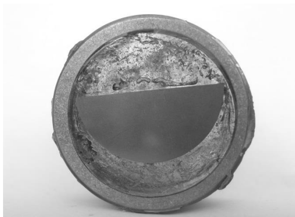
Рис. 2.14. Образцы изготовленные горячим прессованием и холодной заливкой
