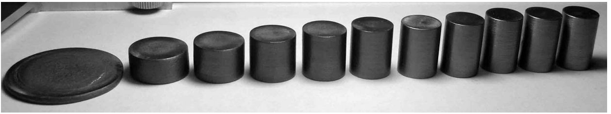
Рис. 2.7. Образцы из ВТ1-2 после испытаний
