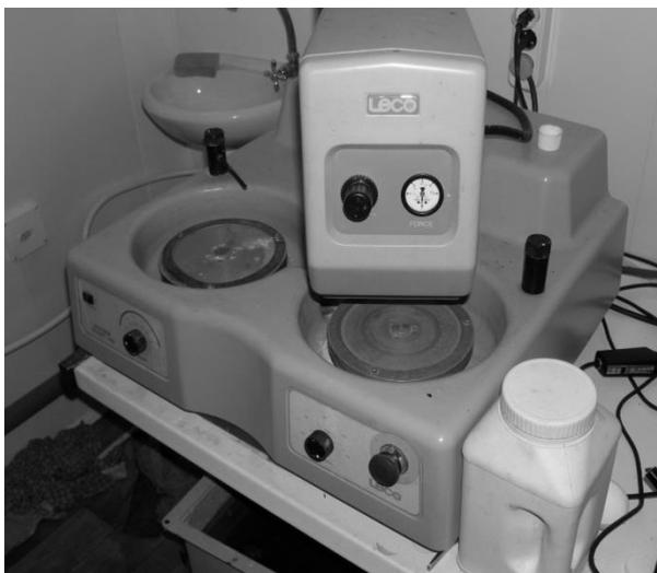
Рис. 2.13. Доводочно-полировальная машина LECO SPECTRUM SYSTEM 1000
