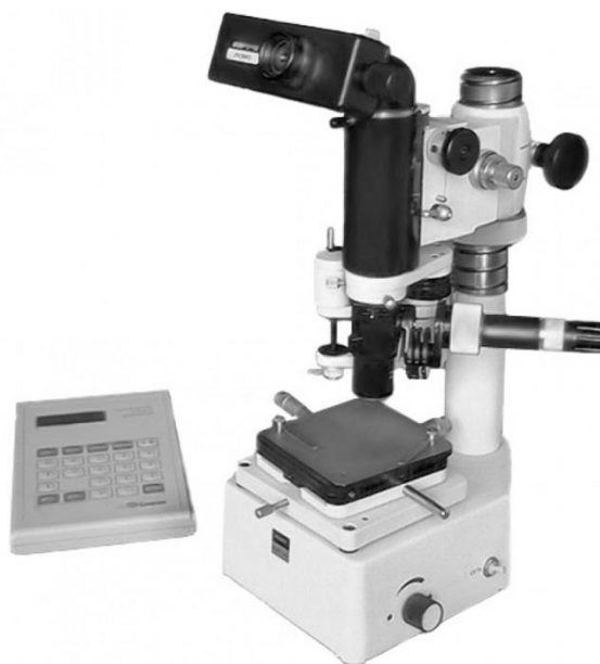
Рис. 2.15. Общий вид микротвердомера ПМТ-3
