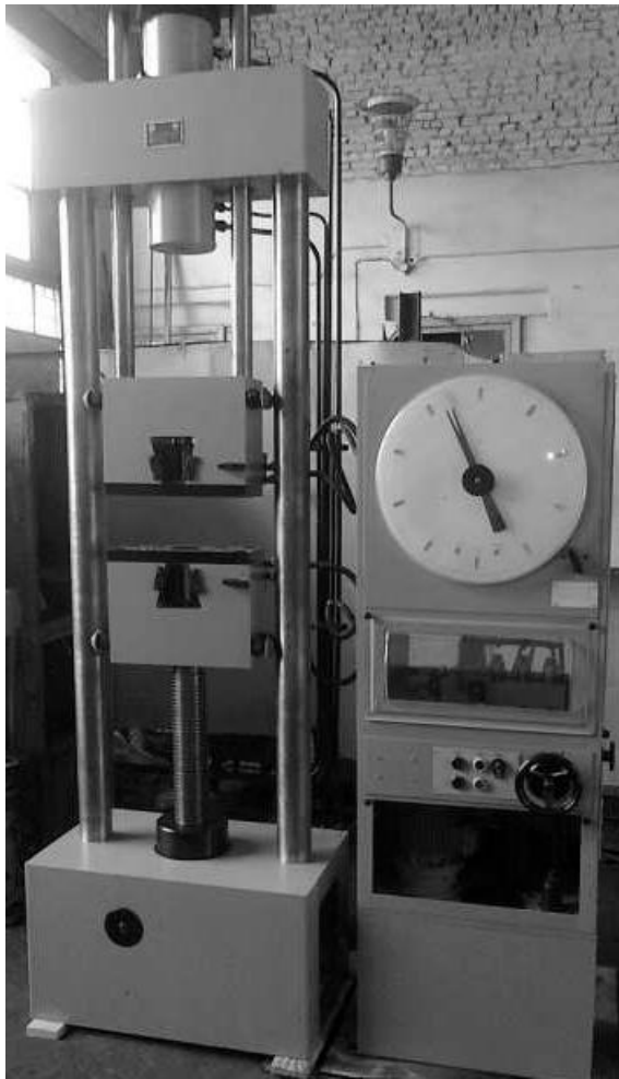
Рис. 2.5. Испытательная машина P20
