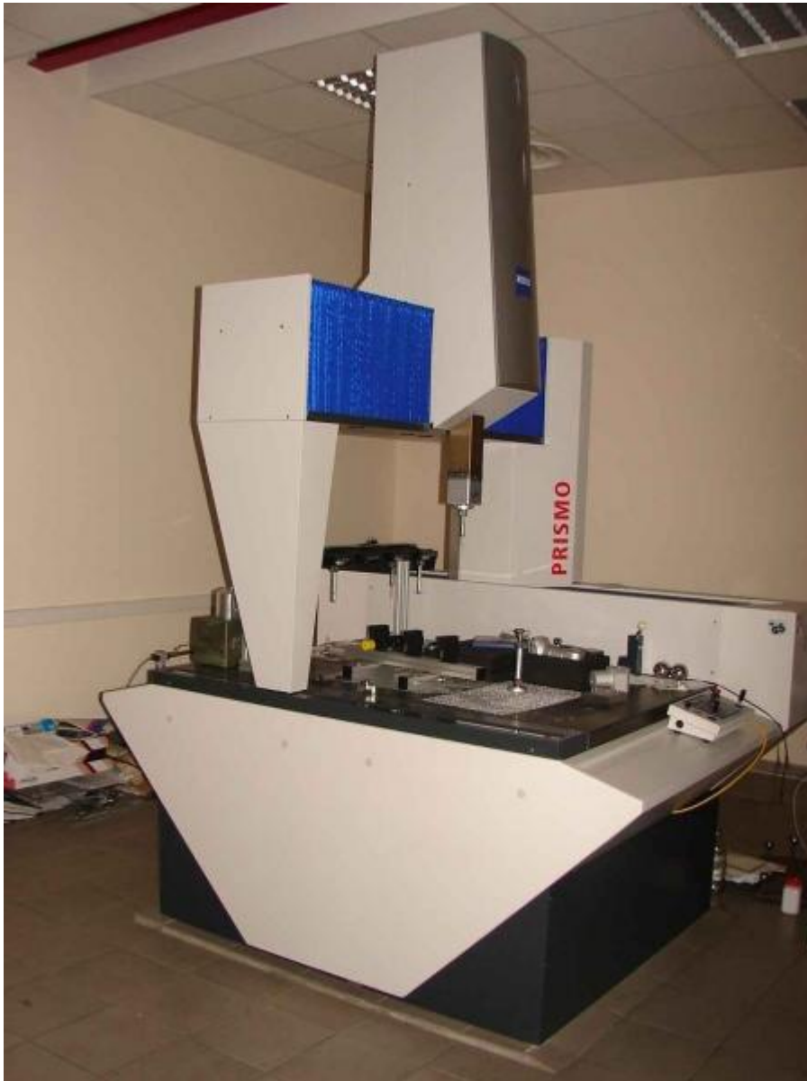
Рисунок 3.5 – Координатно-измерительная машина PRISMO 7
