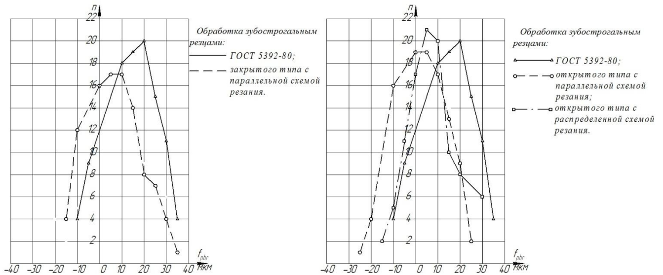
Рисунок 4.11 – Отклонение шага зацепления
