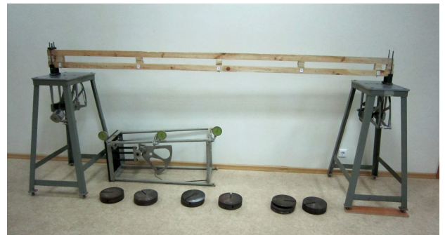
Рисунок 3.12 – Установка для статических испытаний составной балки с переменной жесткостью шва
