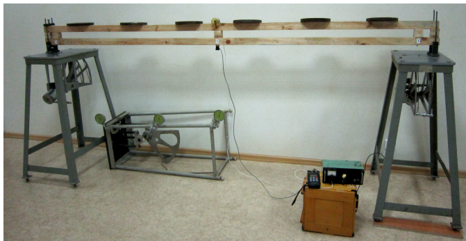
Рисунок 3.11 – Установка для вибрационных испытаний составной балки с переменной жесткостью шва
