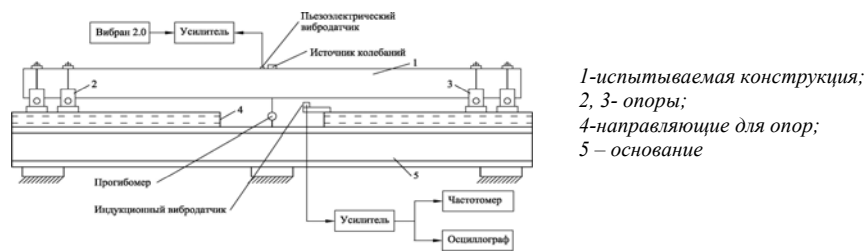
Рисунок 5 – Установка для испытаний деревянных балок
