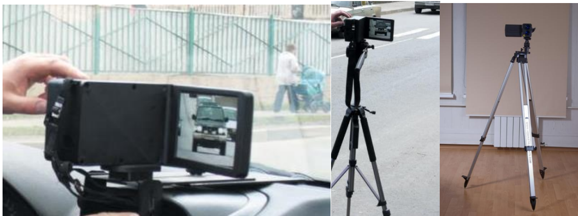
Рисунок 3.6 – Способ установки измерителя скорости АМАТА
