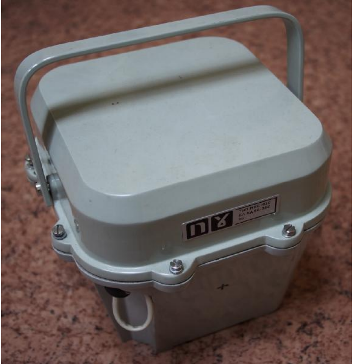
Внешний вид блока детектирования БДКС-05С, применённого в макетном образце нейтронного спектрометра реального времени
