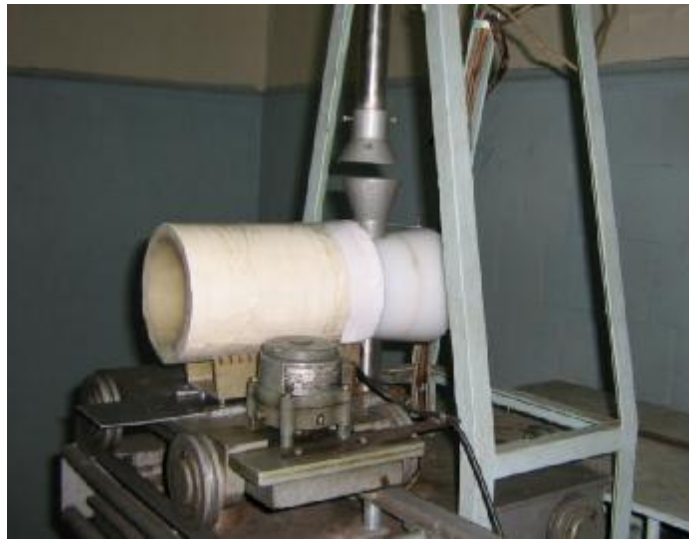
Рисунок 4.12 – Экранирующая система источника, состоящая из отражателя нейтронов и экранирующей трубы (коллиматора)
