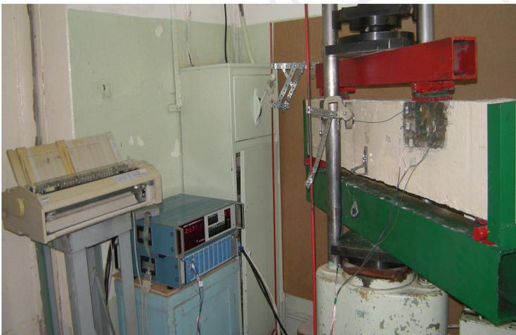
Рис. 3.2. – Общий вид лабораторных испытаний железобетонных составных конструкций по наклонным сечениям
