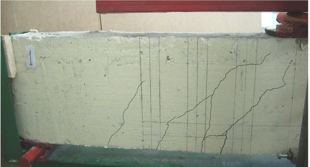
Рис 3.19. Картины образования и развития трещин в опытной конструкции третьей серии БС – III – 2,7 – 100–Ø10–(n2)
