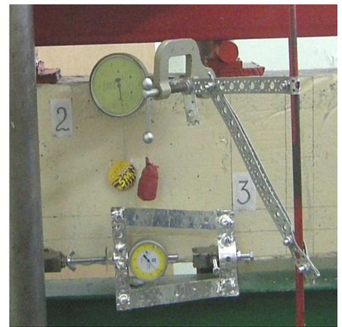
Рис. 3.3. – Установка механических приборов с помощью специальных приспособлений
