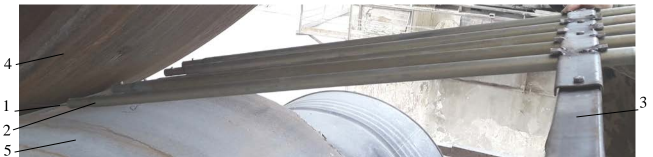
Рис. 4.7. Приспособление для обеспечения направления свинцовой проволоки в измеряемый зазор между бандажом и опорным роликом в принятых координатах u_{sk} точек измерения малая проекция центра которой совпадает с левым торцом бандажа. Направляющие 2 расположены в приспособлении 3, закрепленном на раме роlikоопоры. Толщина проволоки измерялась микрометром «Эталон» МК25-1 ГОСТ 6507-90.
