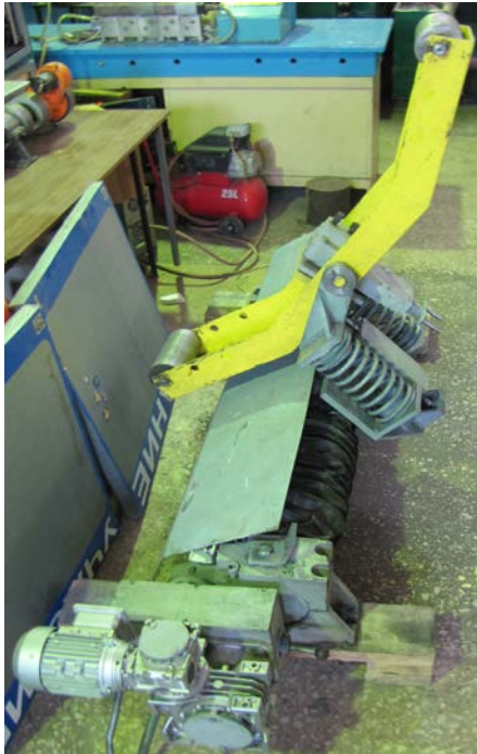
Рис. 1.8. Универсальный встраиваемый станок УВС-01 (БГТУ им. В.Г. Шухова) с динамическим самоустанавливающимся суппортом (ДСС): 1 – бандаж; 2 – опорный ролик; 3 – опорный роликовый блок; 4 – роликовая тележка; 5 – инструмент; 6 – пиноль; 7 – несущий суппорт; 8 – монтажная площадка; 9 – направляющая; 10 – опорная стойка; 11 – сменная технологическая наладка; 12 – корпус подшипника роликосопоры
