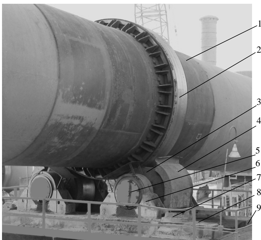
Рис. 1. Опорный узел вращающейся печи 5x185 м для получения цементного клинкера:
