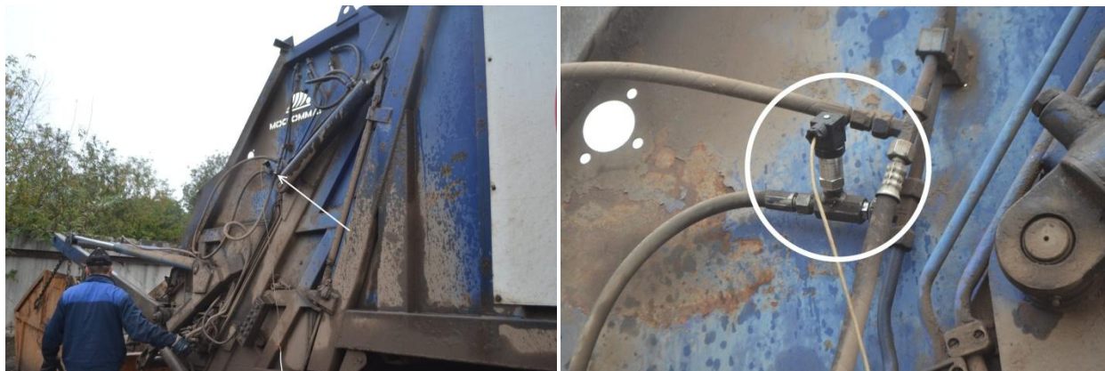
Рисунок 3.3 - Место установки датчика давления.
