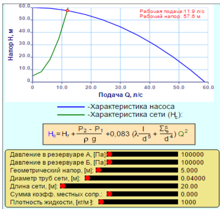
Рисунок 3. Совместная работа центробежного насоса и трубопроводной сети
