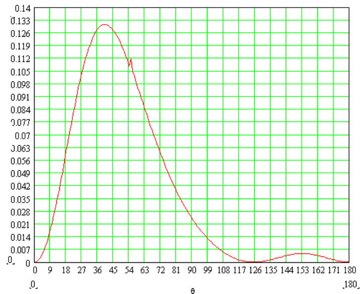
Рис. 5.20 Характеристика излучения открытого конца волновода на волне E_{01} для радиуса раскрыва a = 3\text{ см} и длины волны l = 3.2\text{ см} .
