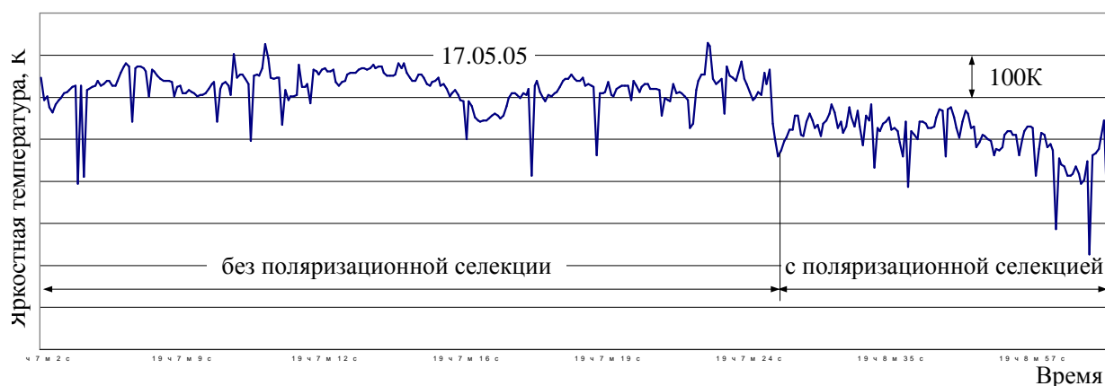
Рис. 7.10 Измерение радиояркого контраста методом поляризационной селекции в одноканальной радиотеплолокационной системе
