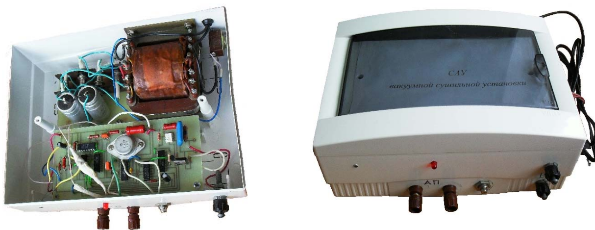
Рис. 8. Внешний вид блока автоматического управления выпариванием.
