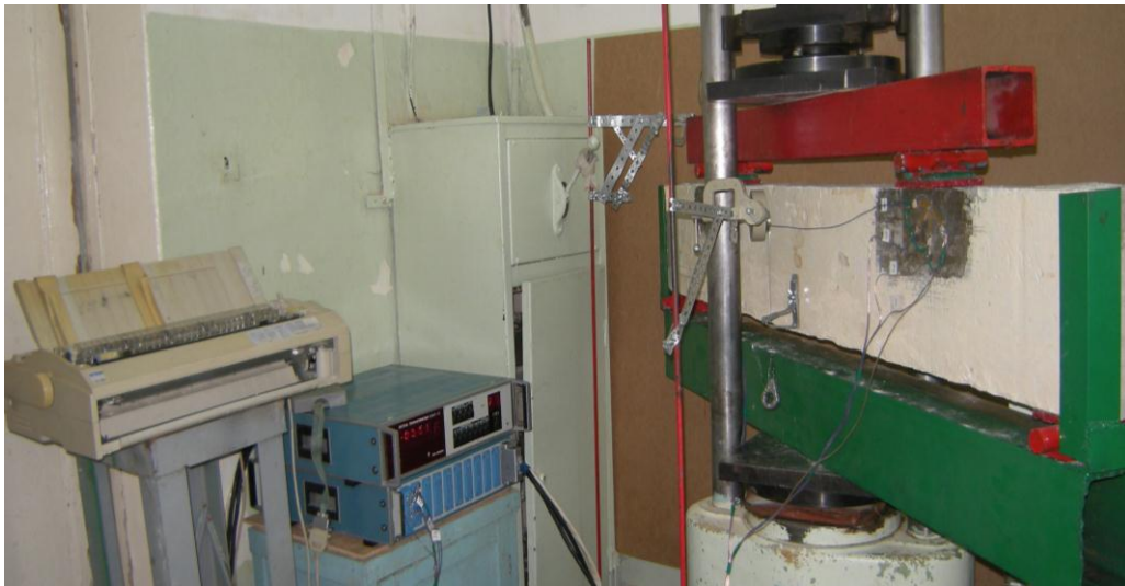
Рисунок 2 – Общий вид испытаний железобетонных составных конструкций по наклонным сечениям
