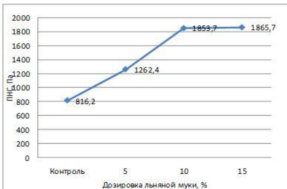
Рисунок 4.3 - Значения предельного напряжения сдвига пищевой композиции в зависимости от дозировки льняной муки
