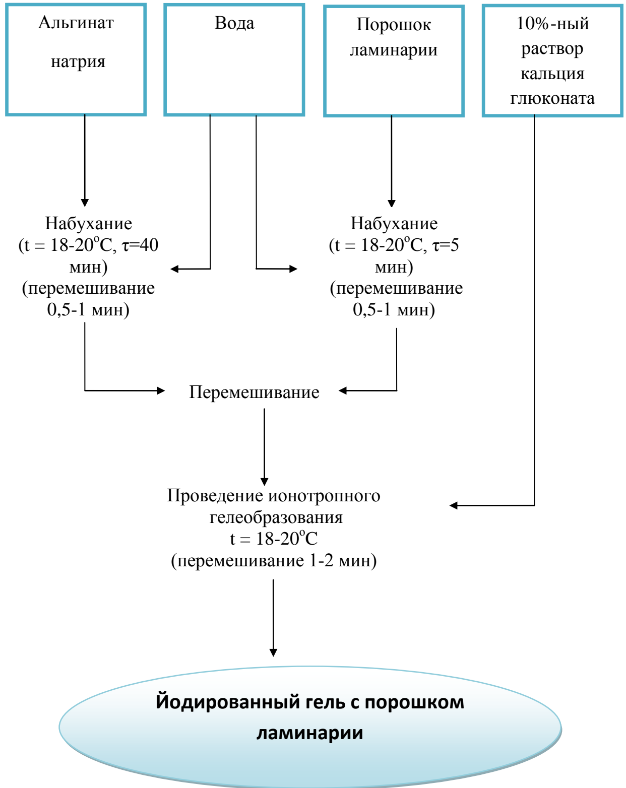
Рисунок 3.7 - Технологическая схема производства йодированного геля с порошком ламинарии
