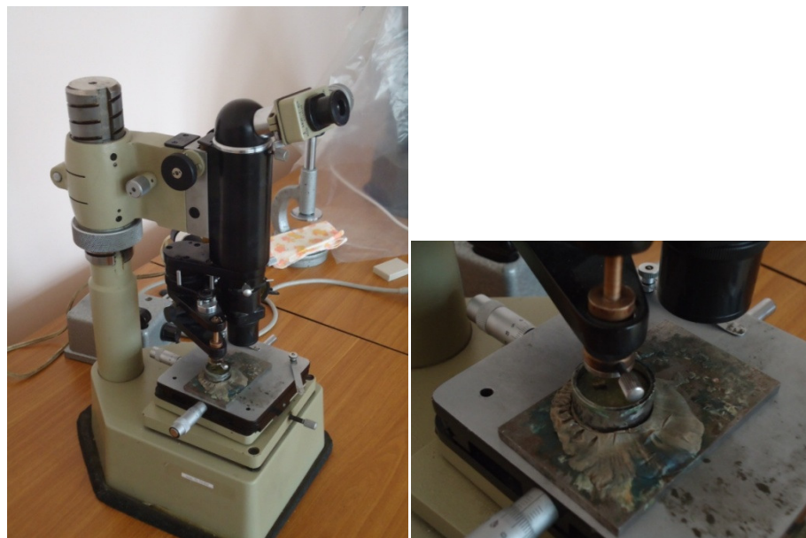
Рисунок 3.3.2 – Процесс измерения микротвёрдости на прирезцовой поверхности стружки на микротвердомере ПМТ-3
