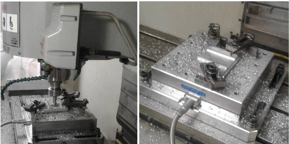
Рис. 2.3. Экспериментальная установка для измерения составляющих силы резания
