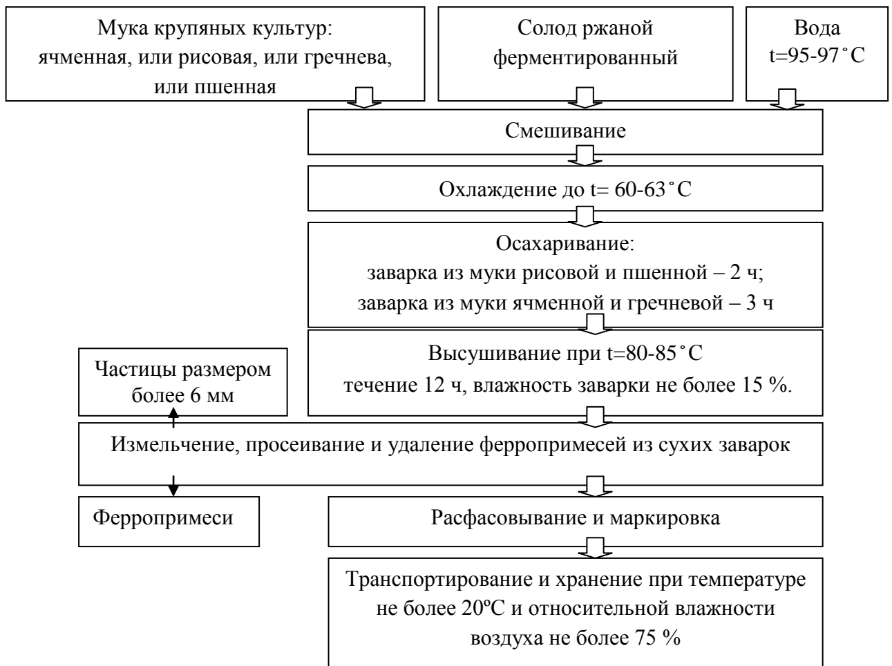
Рисунок 3.32 – Принципиальная технологическая схема производства сухих завтраков из муки крупяных культур
