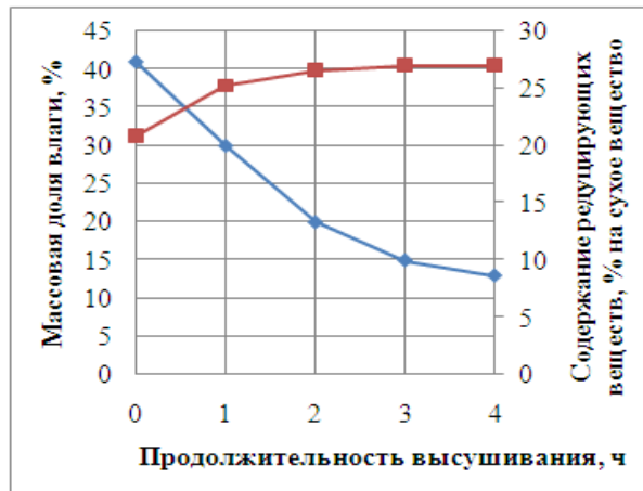
Рисунок 3.13 – Влияние внесения ржаной обдирной муки в качестве осушителя пасты полуфабриката картофельной массы на массовую долю влаги и содержание редуцирующих сахаров
