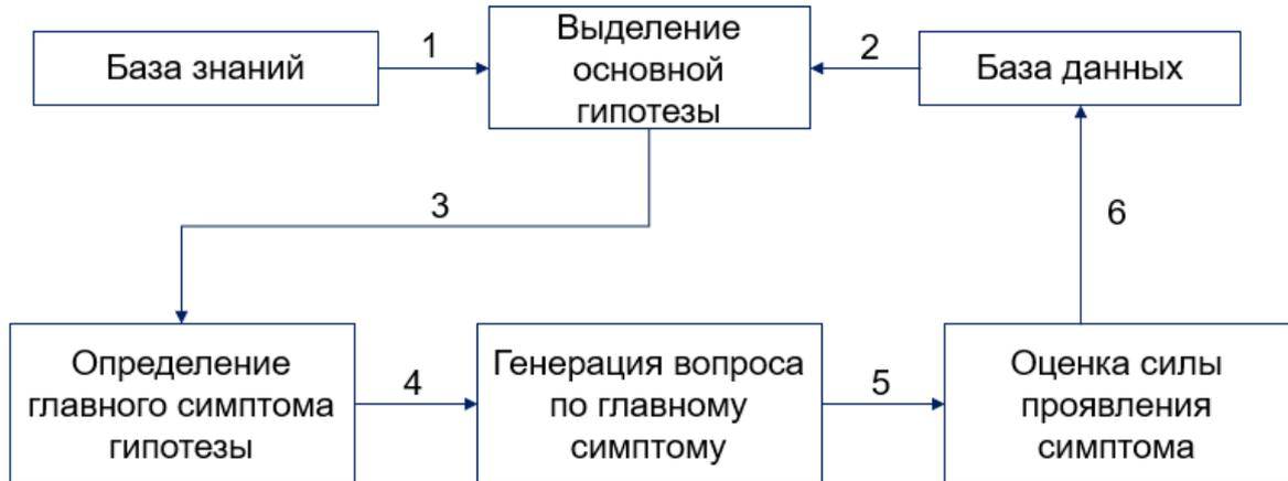
Рисунок 3.8 – Структурная схема генерации вопросов автовладельцу для установления диагноза ЭС
