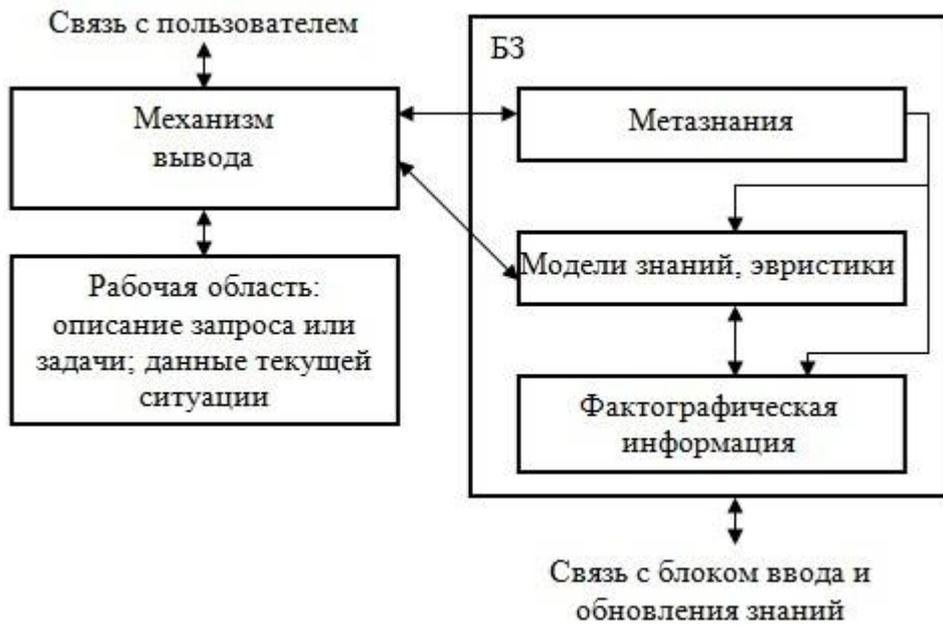
Рисунок В.3 – Структура взаимодействия БЗ с основными компонентами ИИС для продукционных систем
