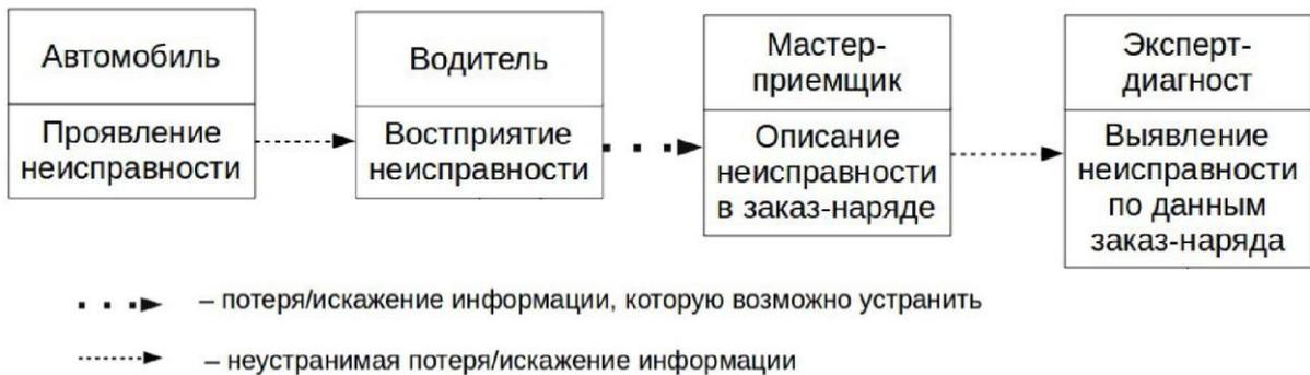
Рисунок 1.1 – Существующая схема последовательности выявления и устранения неисправности частного автомобиля
