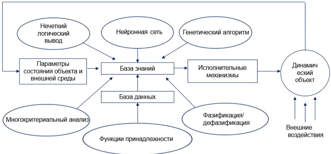
Рисунок 1.4 – Блок-схема БЗ планируемой ЭС
