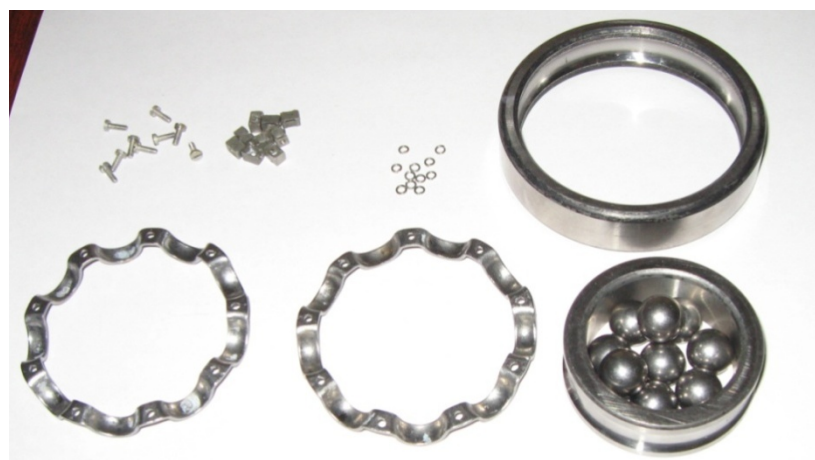
Рисунок 4.3– Фотография разобранного подшипника
