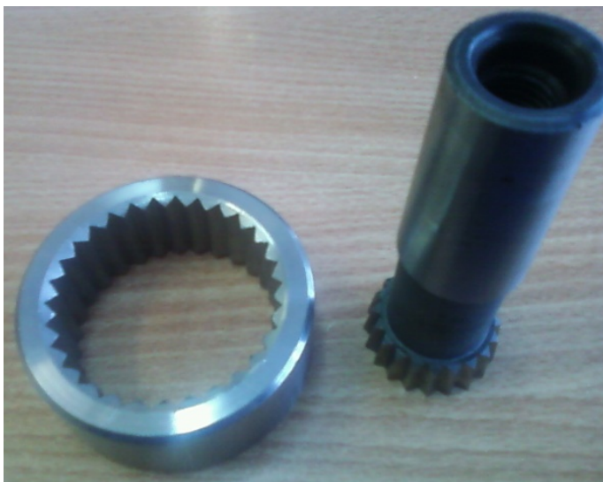
Рис. 4. Спрофилированный инструмент и изготавливаемое изделие
