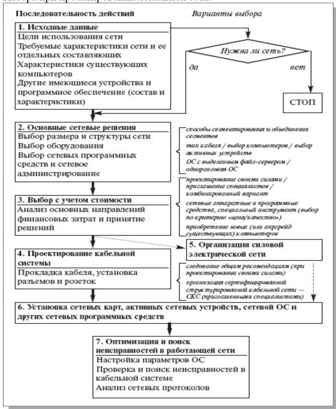
Рисунок 1 - Примерная последовательность этапов и варианты выбора при проектировании ЛС
