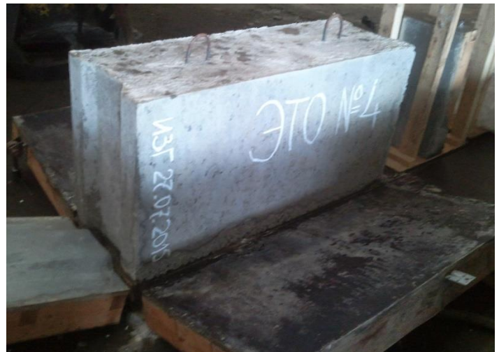
Рисунок 2 - Внешний вид опалубки в процессе ЭТО при изготовлении фундаментных блоков типа ФБС 12.4.6 в начальный момент (слева) и готового изделия после распалубки (справа): на рисунке слева на переднем плане слева направо – счетчик электроэнергии, источник питания повышенной частоты мощностью 4,5 кВт и портативный осциллограф для регистрации напряжения на электродах опалубки
