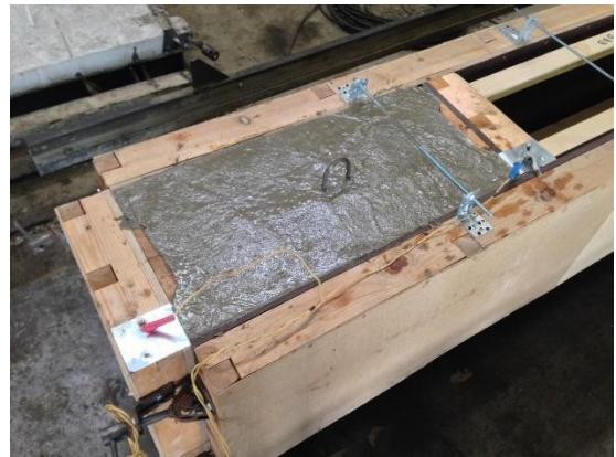
Рисунок 1 - Внешний вид опалубки для изготовления фундаментных блоков до (слева) и после (справа) укладки свежего бетона: электроды установлены на торцевых поверхностях опалубки, т.е. электрический ток протекает вдоль блока
