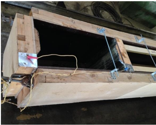
Рисунок 1 - Внешний вид опалубки для изготовления фундаментных блоков до (слева) и после (справа) укладки свежего бетона: электроды установлены на торцевых поверхностях опалубки, т.е. электрический ток протекает вдоль блока
