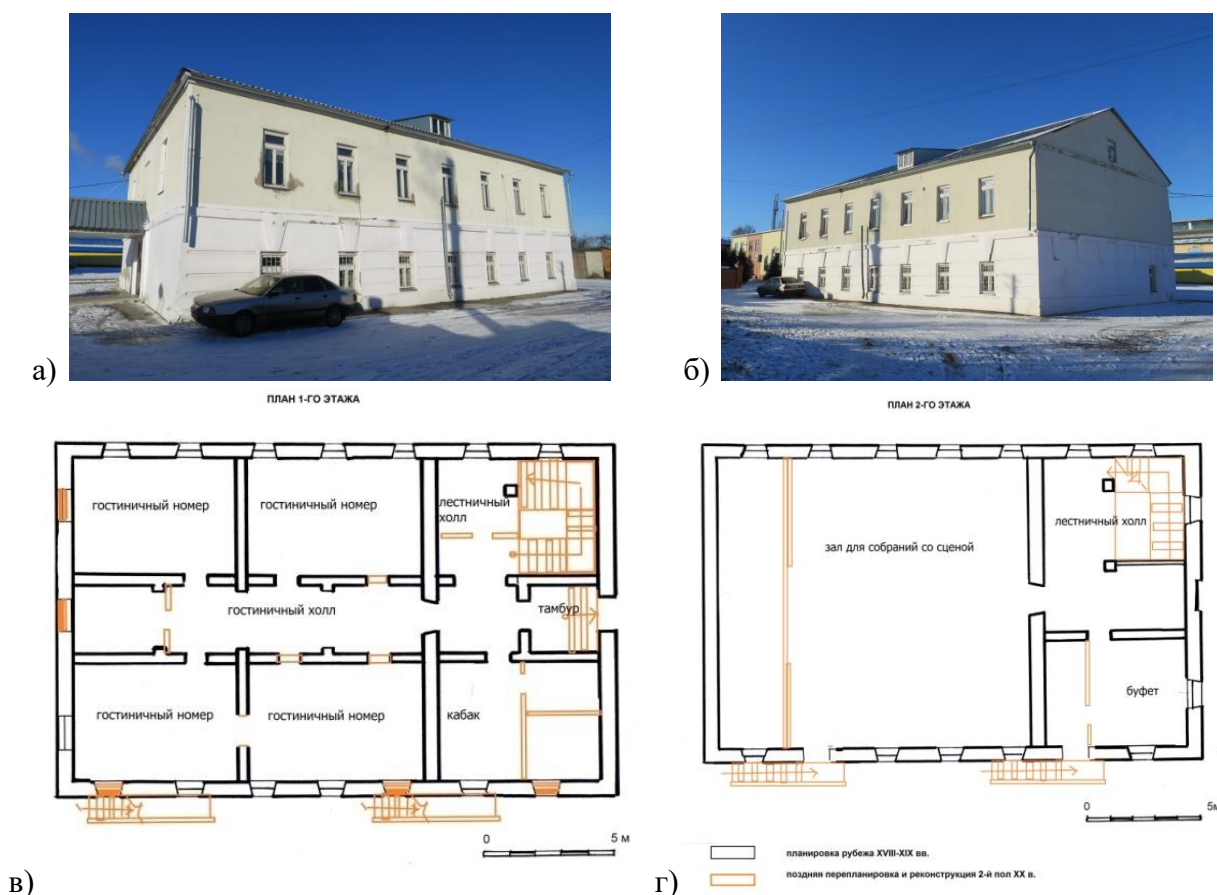
Рисунок 14 - Гостиница «Борисов», фото и обмеры автора, 2020 г.: а-б) виды фасадов, в) план 1-го этажа, г) план 2-го этажа.
