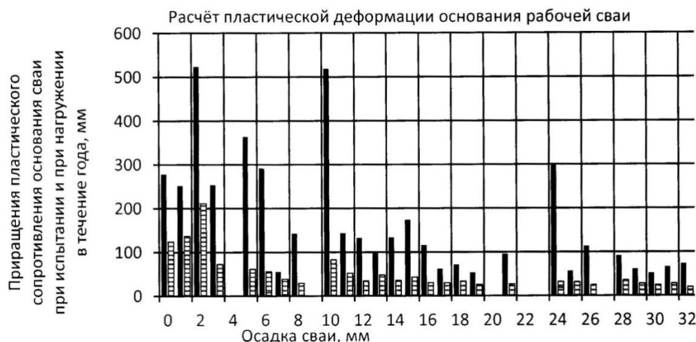
Рисунок 3 – Изменение пластической составляющей осадки модельной сваи (показано горизонтальной штриховкой) и рабочей сваи (сплошная заливка) при её нагружении в течение года
