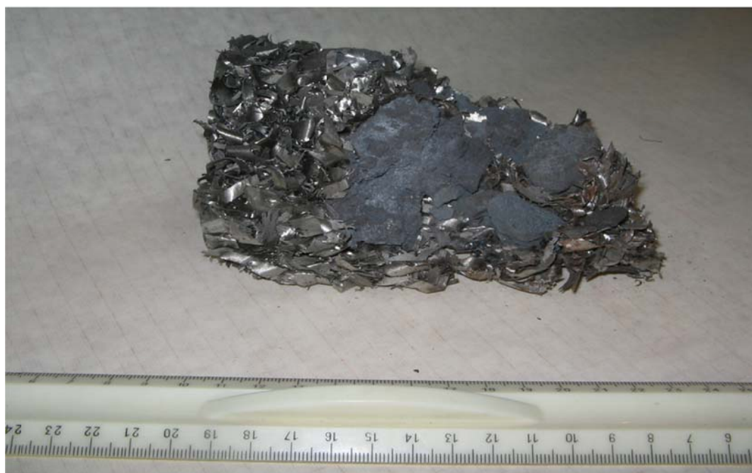
Рисунок 4 – Фотография фрагмента композитного брикета из стружки стали Ст. 3 с добавкой кусков материала с малой электропроводностью (горной породы) Размер брикета: 200х60х60 мм; плотность 1,4 г/см 3 ; масса 1 кг (400 г стружки и 600 г породы)
