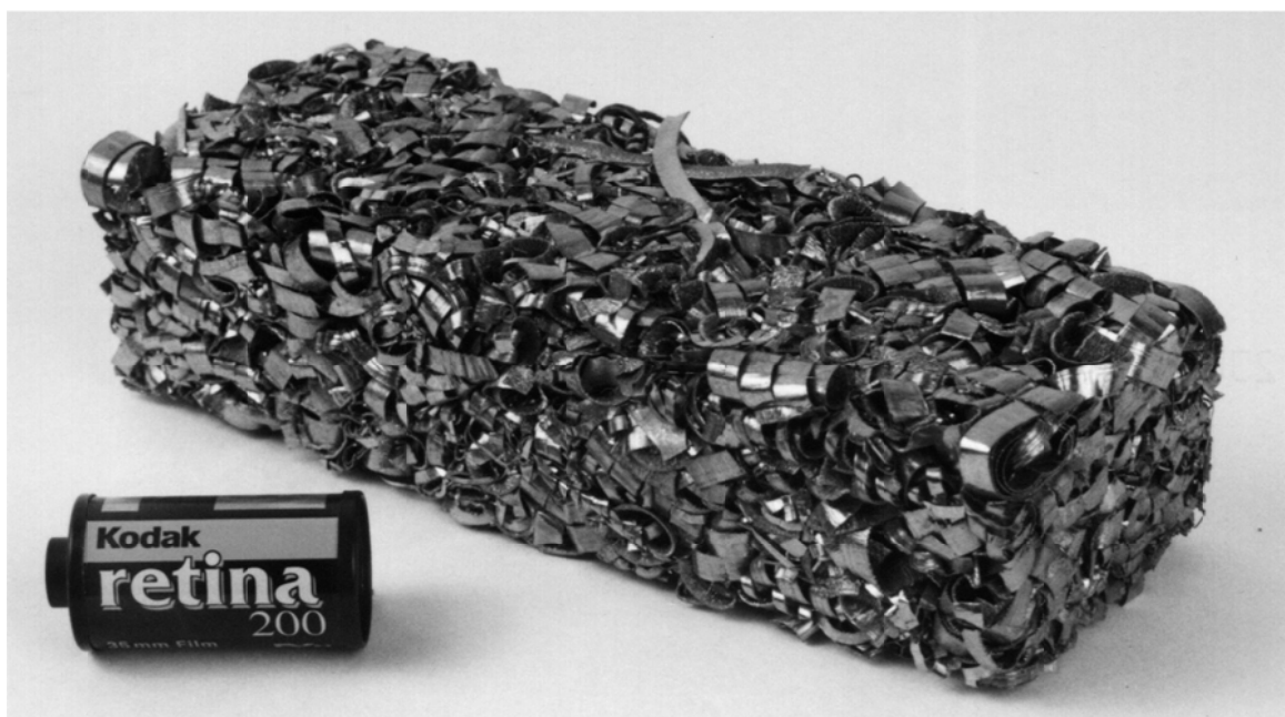
Рисунок 3 – Фотография пробного брикета. Стружка титанового сплава 3М Размер брикета: 175х64х50 мм; плотность 1,1 г/см 3 (пористость 75%); масса 590 г
