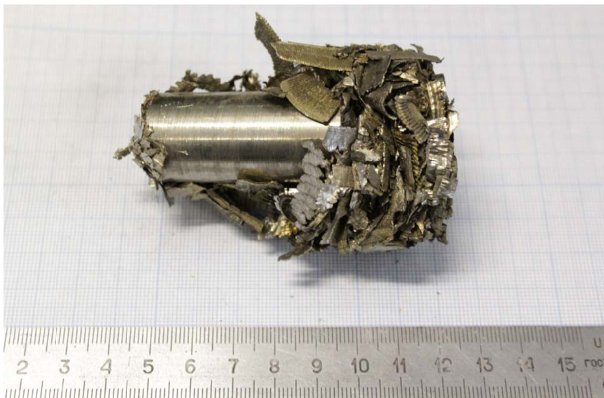
Рисунок 5 – Фотография фрагмента брикета из стружки высокопрочного титанового сплава BT20 с добавлением крупных кусков титана с размером: диаметр: 20 мм, длина: 48 мм, массой 68 г. Размер брикета: диаметр 50 мм, высота 90 мм; масса 215 г плотность 1,2 г/см 3
