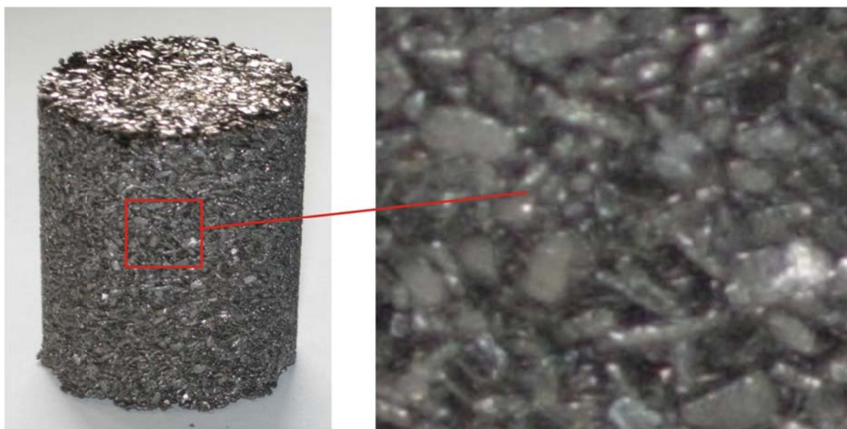
Рисунок 6 – Брикет из порошка титана (диаметр 35, высота 46,5 мм; масса 103 г, плотность 2,3 г/см 3 ; пористость 50%; осыпь порошка 2,5 г, 2,4 %) и увеличенное изображение его центральной части 1х1 см
