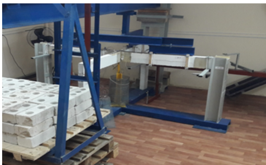
Рисунок 6 - Общий вид разрушения конструкции рамы после запроектного воздействия.
