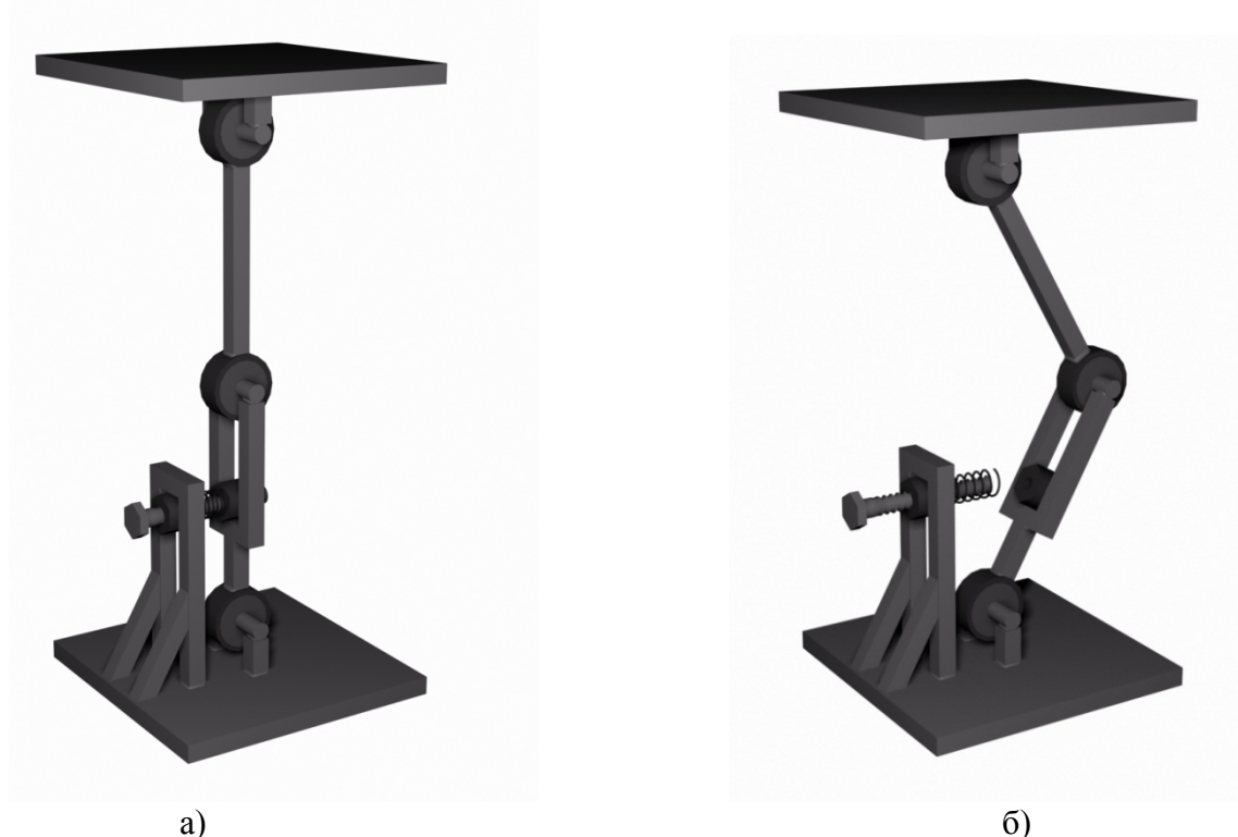
Рисунок 3 – Устройство выключающей связи (а – в проектном положении; б – при моделировании выключения элемента)
