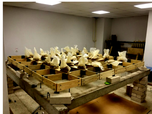
Рисунок 5- Загружение СПБ сосредоточенной нагрузкой в центральных узлах
