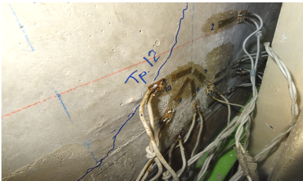
Рисунок 2 – Общий вид установки электротензорезисторов на бетон
