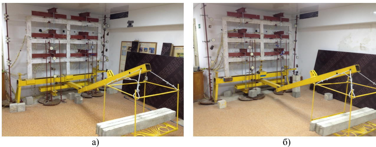
Рисунок 1 – Общий вид испытательного стенда при испытаниях рам (а – первой серии; б – второй серии)
